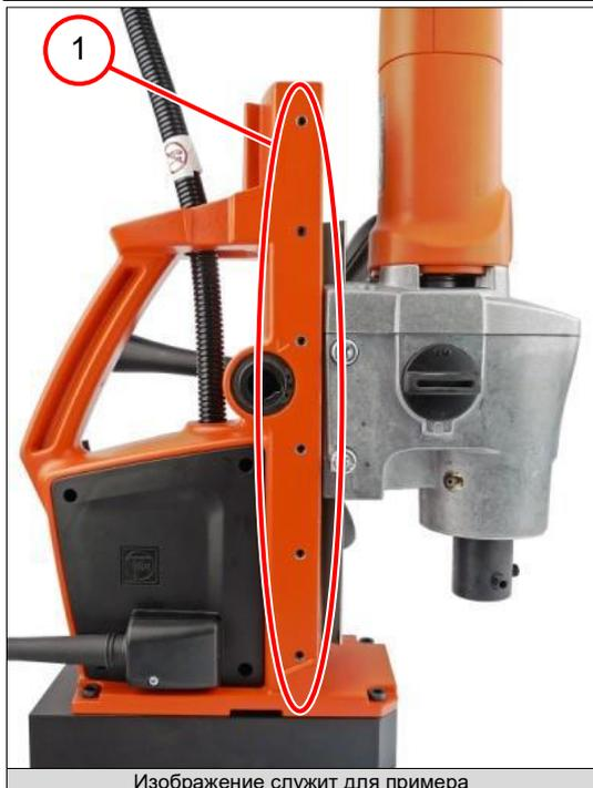
1. С помощью шести резьбовых штифтов (1) добейтесь отсутствия зазора направляющей.
