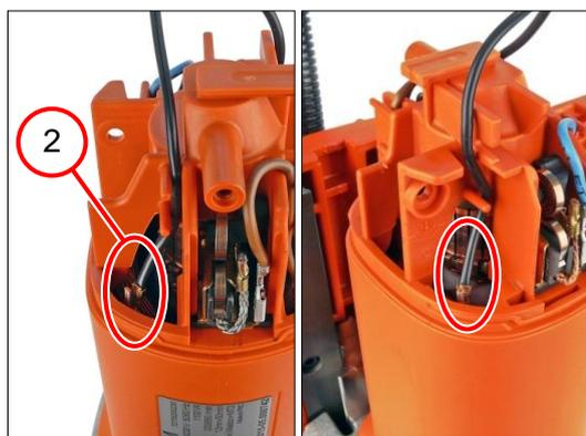
2. Подсоедините два провода (2) согласно схеме соединений.
