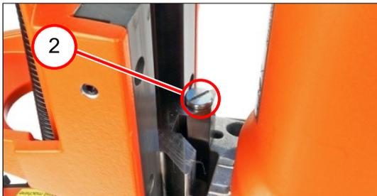
4. Serrer la vis à tête plate (2) [1,2 Nm  $\pm$ 0,15 Nm].
