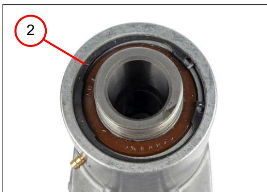
2. Placer le circlips (2).
