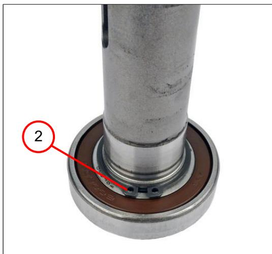
2. Placer le circlips (2).
