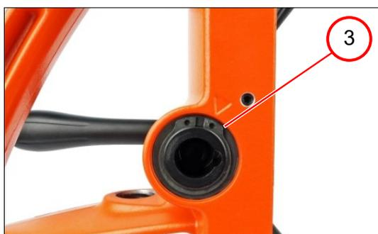
4. Placer le circlips (3).
