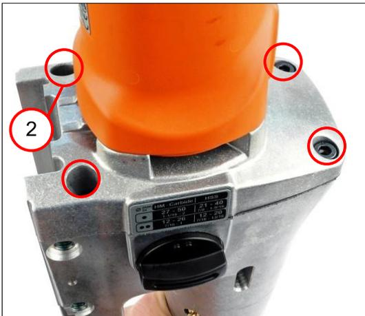
2. Serrer les quatre vis (2) [8,0 Nm  $\pm 0,3$  Nm].
