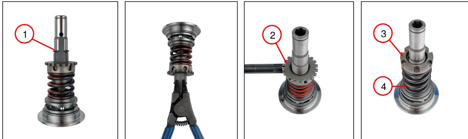
1. Den Sicherungsring (1) entfernen.
