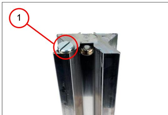
7. Serrer la vis à tête plate (1) [1,2 Nm  $\pm 0,15$  Nm].
