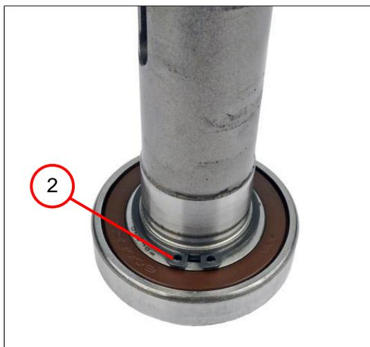
2. Placer le circlip (2).
