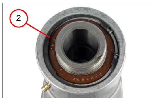
3. Placer le circlip (2).
