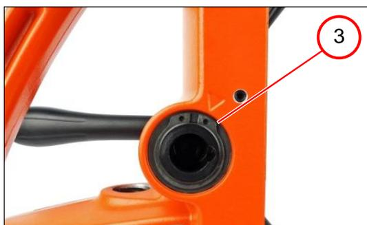
4. Placer le circlip (3).
