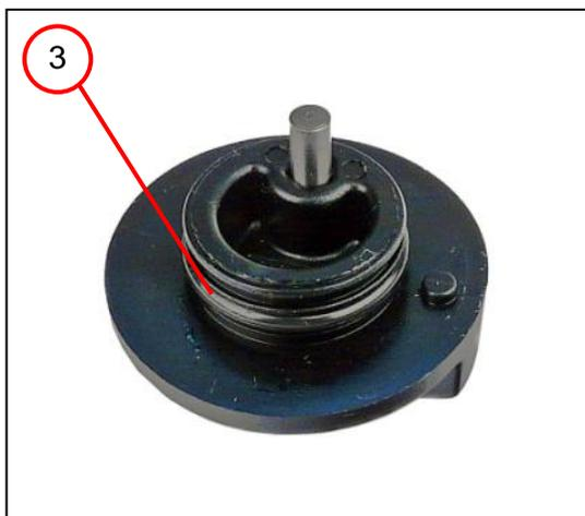
3. Retirer la bague d'étanchéité (3).
