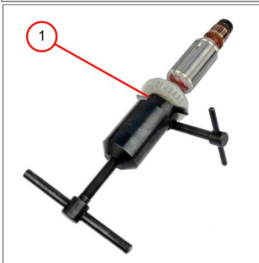
1. Снимите радиальный шарикоподшипник (1).
