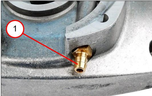
3. 拧出软管连接装置（1）。
