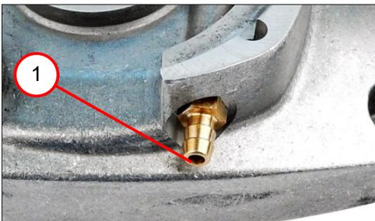
5. 拧入软管连接装置 (1) [1.8 Nm  $\pm 0.1$  Nm]。
