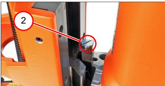
4. 拧入平头螺栓（2）[1.2 Nm  $\pm$ 0.15 Nm]。
