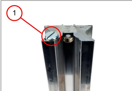
7. 拧入平头螺栓（1）[1.2 Nm  $\pm$ 0.15 Nm]。
