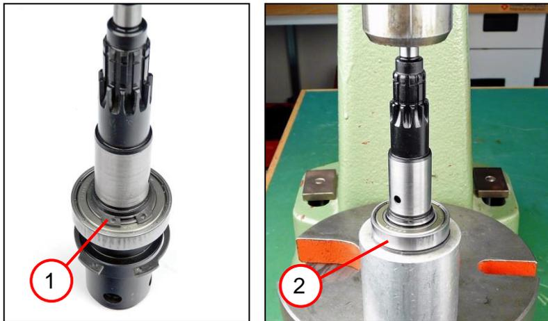
1. Den Sicherungsring (1) entfernen.
