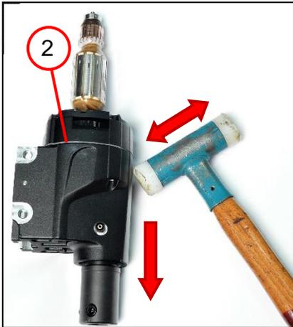
1. Das Getriebegehäuse (1) entfernen.
