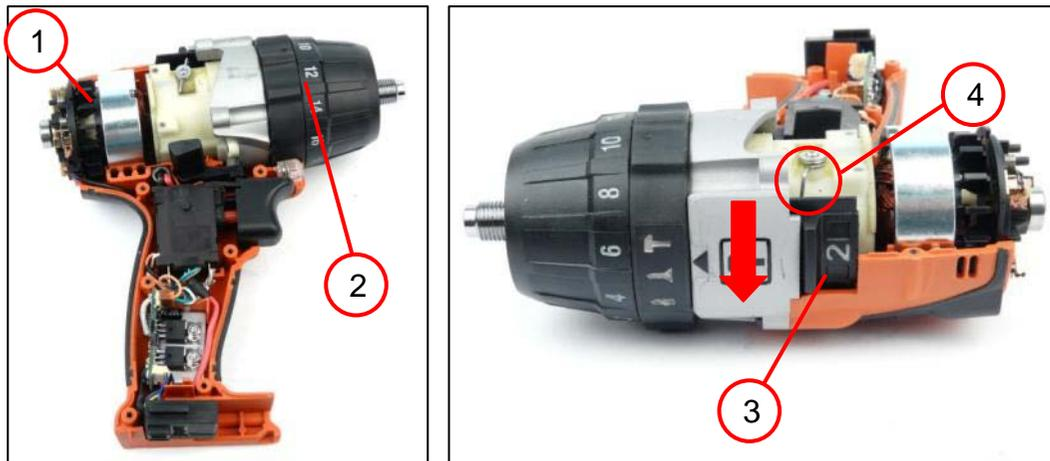
1. Den Anker (1) leicht anheben und das Getriebe (2) einbauen.
