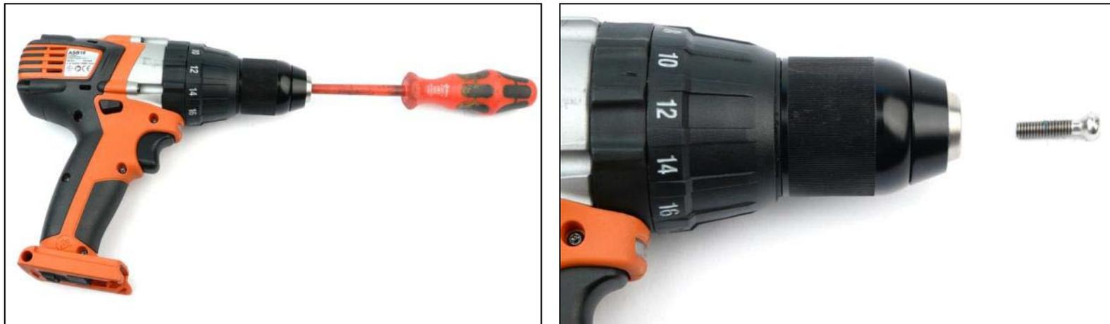
1. Die Schraube (Linksgewinde) im Schnellspanbohrfutter heraus-schrauben.
