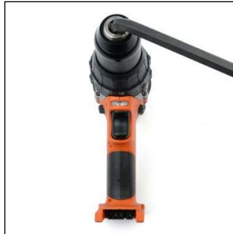
1. Den Inbusschlüssel im Schnellspanbohrfutter befestigen.
