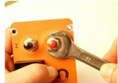
1. Erdungskabel an Deckel Elektronikgehäuse entfernen.
