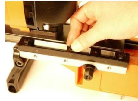
1. WAGO Klemmen anschließen und Schutzleiter an Führungsplatte anschrauben.
