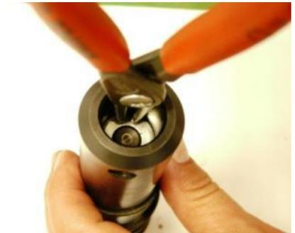
1. Bohrwelle demontieren.
