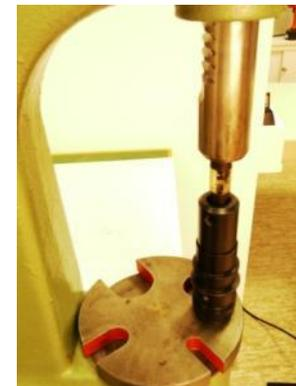
1. Dichtringe aufsetzen und Druckstück einführen
