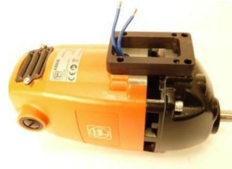
1. Verbindungskabel Elektronik – Motor durch die Öffnung der Führungsplatte schieben.
