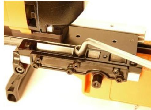
1. Einstellplatte für Schwalbenschwanzführung an Gehäuse befestigen.
