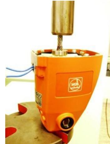
1. Lager mit Hilfe von Hülse und Kugellagerauflage aufpressen .
