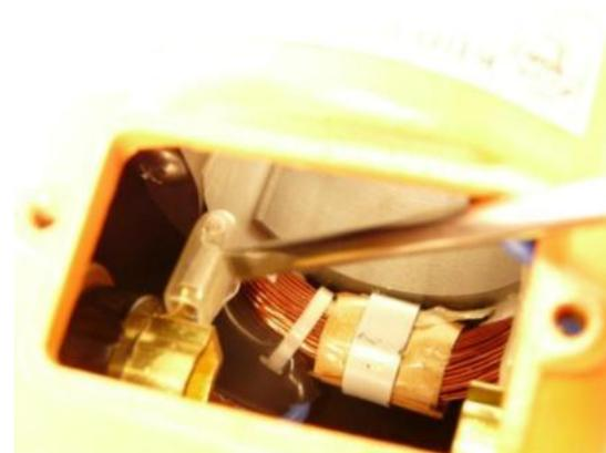
1. Statoranschlusskabel durch Dichtung des Motorgehäuses stecken.
