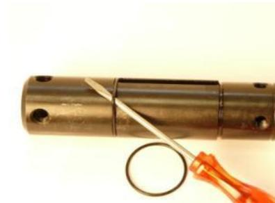
1. Sicherungsring entfernen.
