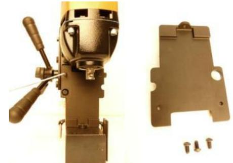
1. Halter für Bohrwelle abschrauben
