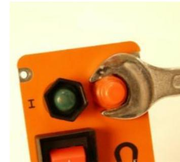
1. Hauptschalter in Deckel für Elektronikgehäuse montieren.
