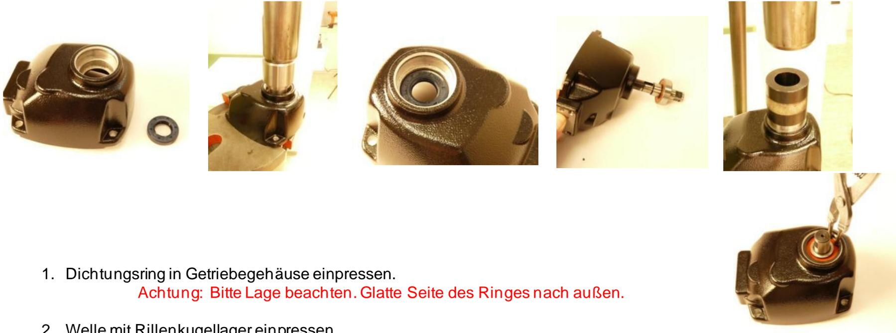
1. Dichtungsring in Getriebegehäuse einpressen.
