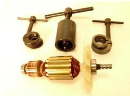
1. Ankerwelle aus dem Getriebegehäuse heraus ziehen.
