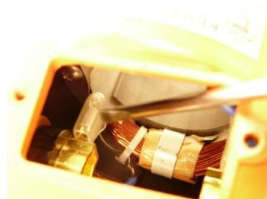
1. Enfiler le câble de raccordement au stator dans le joint du carter moteur.
