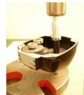
1. Introduire la clavette et la roue dentée.
