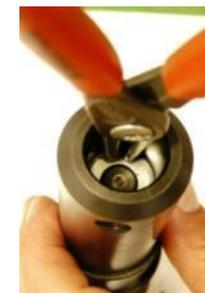
1. Mettre en place les anneaux d'étanchéité et introduire l'élément de pression.
