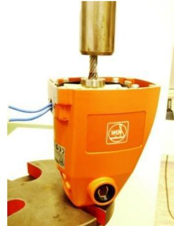
1. Comprimer le palier à l'aide de la douille et du support de roulement à billes.
