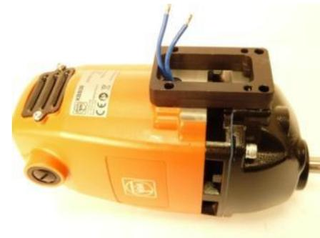
1. Faire glisser le câble de connexion entre le système électronique et le moteur par l'ouverture de la plaque de guidage.
