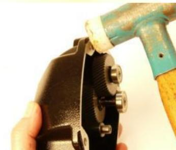
1. Avec un tournevis, faire levier sur le palier intermédiaire pour le désolidariser du carter d'engrenage.
