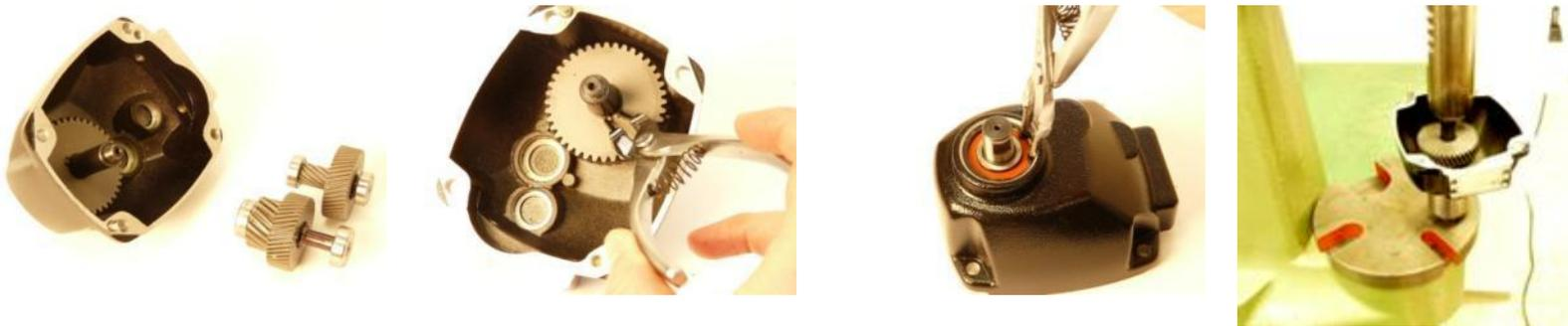
1. Retirer le circlips au niveau de la roue dentée.
