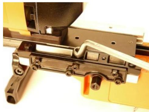
1. Fixer la plaque de réglage du guidage en queue d'aronde au boîtier.
