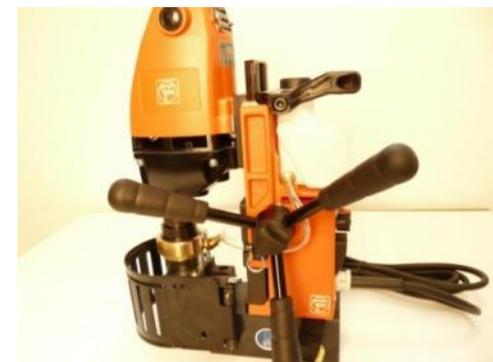
1. Introduire l'arbre de perçage et le fixer à l'aide d'une petite vis sans tête.
