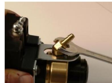
1. Monter le support avec le palier pour l'arbre de perçage.
