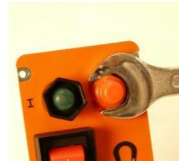
1. Monter l'interrupteur principal dans la tôle de recouvrement de boîtier électronique.
