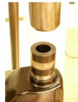
1. Comprimer l'anneau d'étanchéité pour l'introduire dans le carter d'engrenage.
