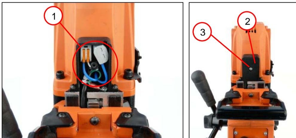
1. Placer les bornes et les câbles (1) dans le couvercle.
