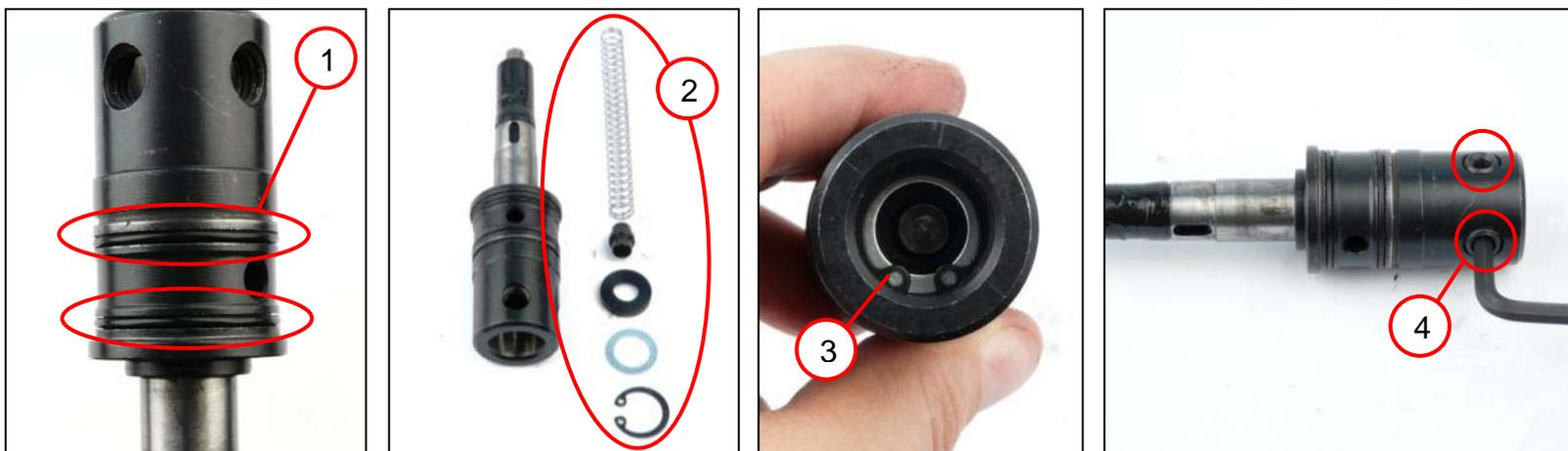
1. Installer les deux anneaux (1) dans la rainure correspondante et les graisser légèrement.
