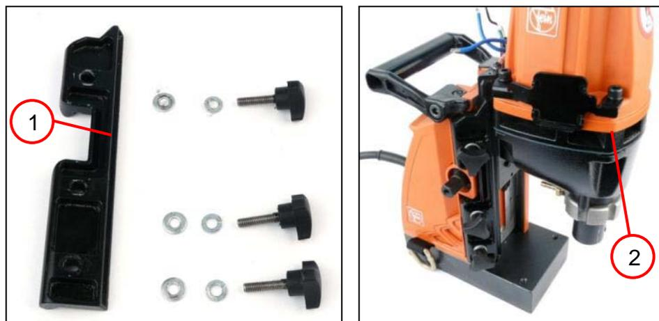
1. Placer le guidage (1) et le fixer avec les trois boutons tournants et deux disques chaque.
