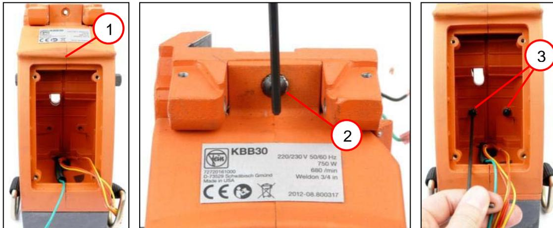
1. Placer le carter (1) et fixer avec la vis (2), le disque denté et le disque.
