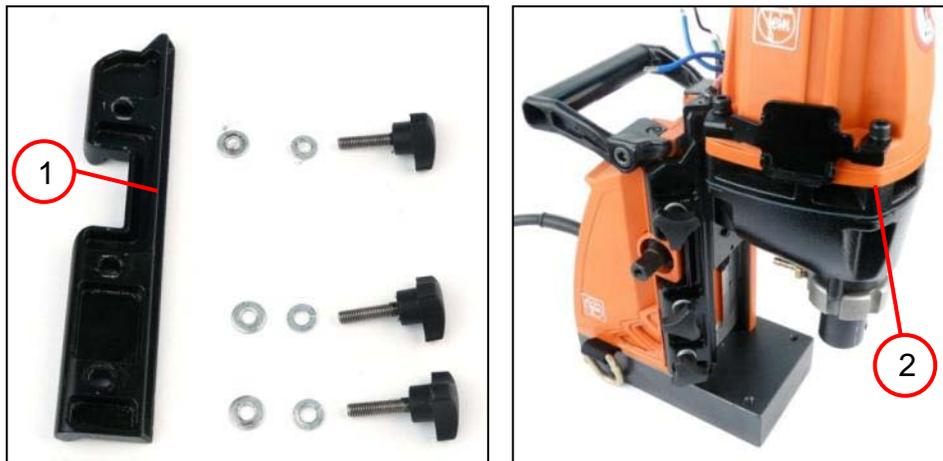
1. Die Führung (1) anlegen und diese mit den drei Drehknöpfen und den je zwei Scheiben befestigen.
