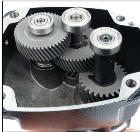
1. Die zwei verzahnten Wellen zusammen stecken und in das Getriebegehäuse einbauen.
