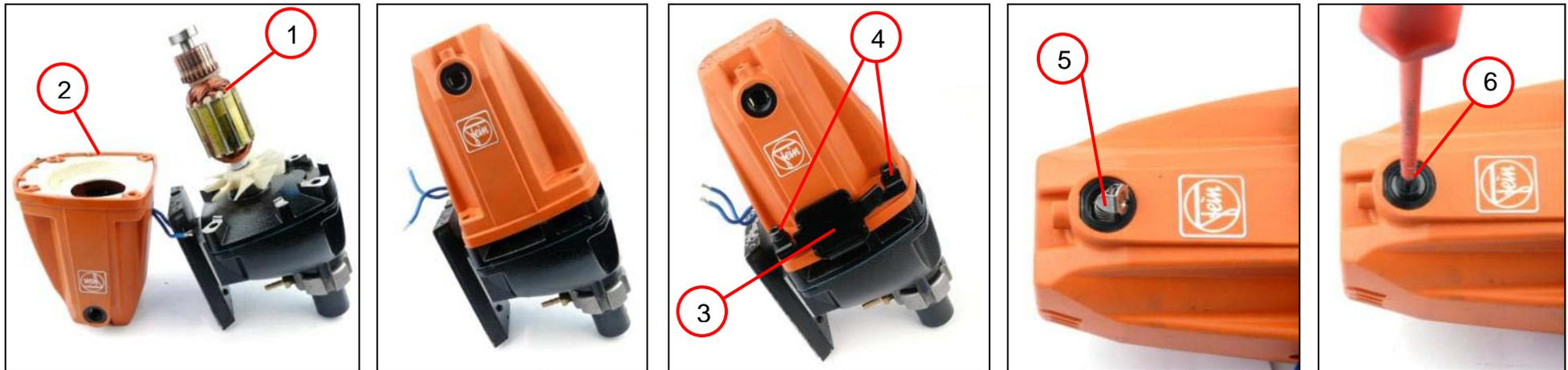
1. Den Anker (1) auf das Getriebe stecken.
