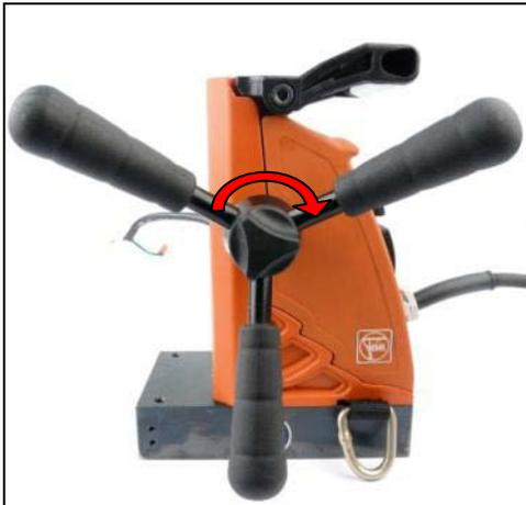
1. Das Anschlussstück auf die Welle schrauben.
