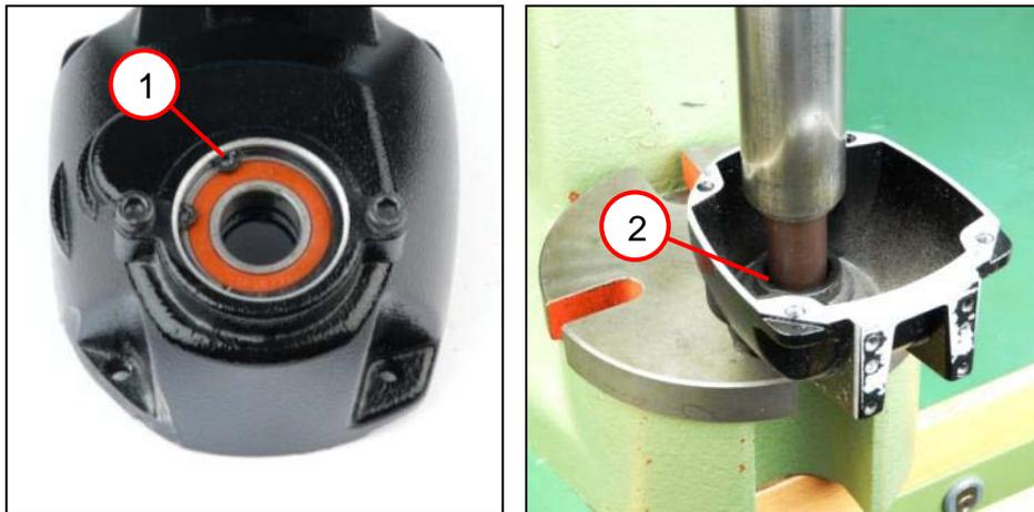
1. Den Sicherungsring (1) entfernen.
