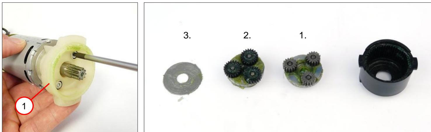
1. Установите фланец (1) на двигатель.
