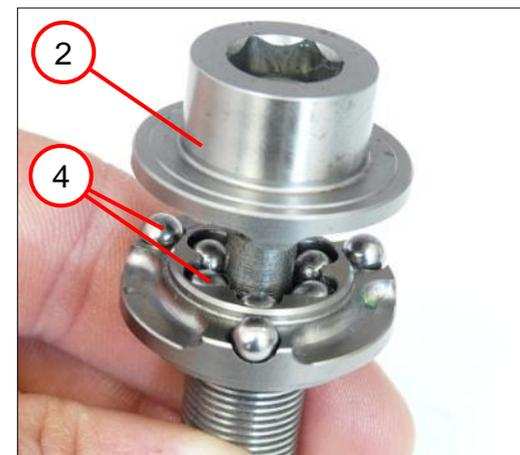
1. Смажьте конец инструментального держателя и переключающую втулку (2) консистентной смазкой.
