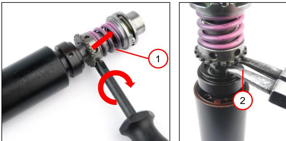
1. Сильно сожмите пружину (1), чтобы получить максимальный доступ к стопорному кольцу.
