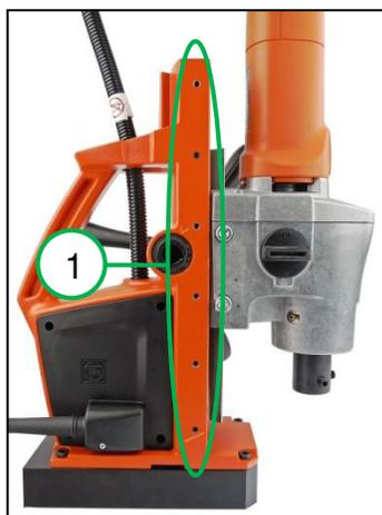
1. 借助六颗螺销（1）调节导向装置的间隙。
