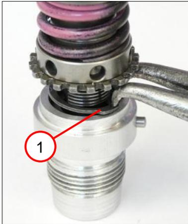
1. Den Sicherungsring (1) einsetzen.
