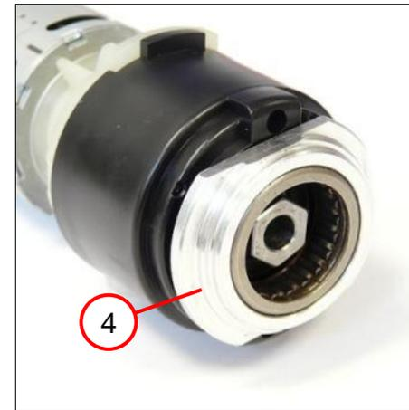
1. Die Scheibe (1) bündig in das Getriebe einlegen.
