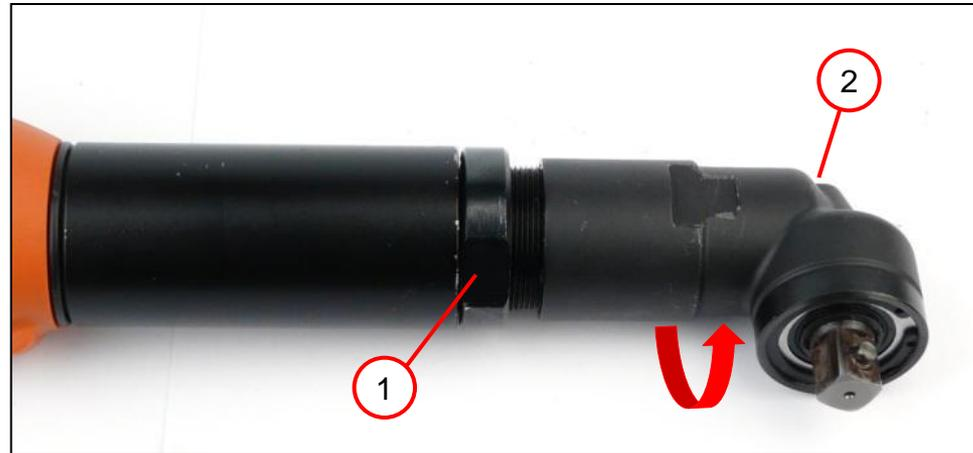
1. Den Gewinding (1) festhalten und den Winkelkopf (2) abschrauben (Linksgewinde).
