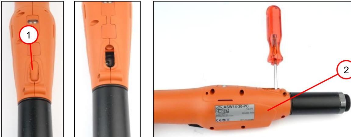
1. Den Schiebedeckel (1) in das Gehäuse schieben.
