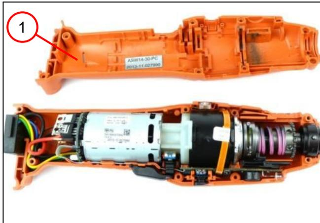
1. Das Gehäuse-Oberteil (1) entfernen.
