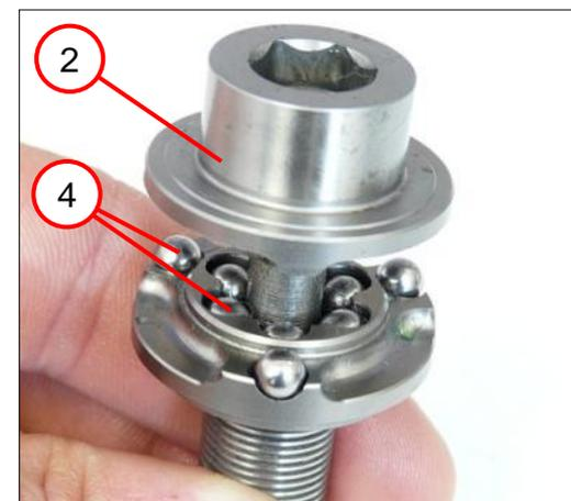
1. Badigeonner de graisse l'extrémité du porte-outil et l'anneau de commande (2).
