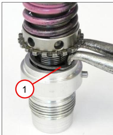
1. Installer le circlips (1).
