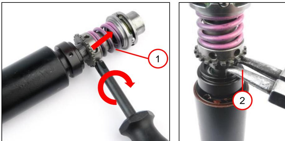
1. Serrer le ressort (1) au maximum afin d'obtenir un meilleur accès au circlips.
