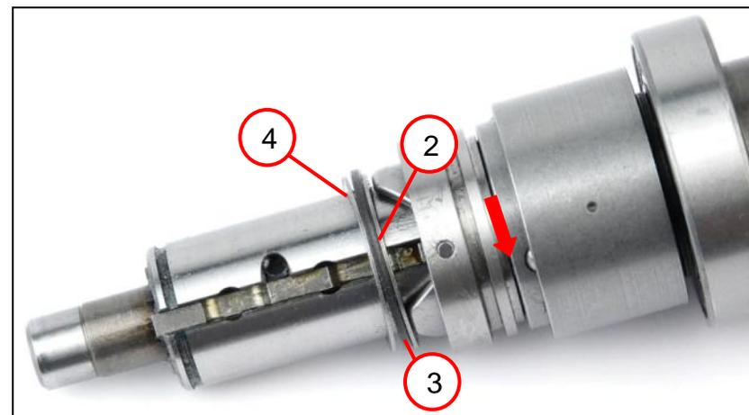
1. Positionner, en la tournant, la bague (1) et la douille de sélection dans la douille de commande et les maintenir en position.
