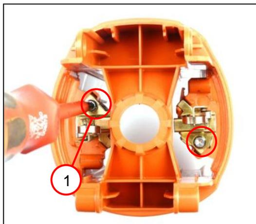
1. Insérer les deux porte-balais (1) et les fixer avec la vis prévue à cet effet.
