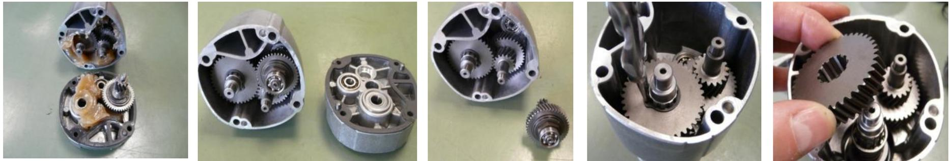
**Getriebegehäuse und Zwischenlager trennen.
