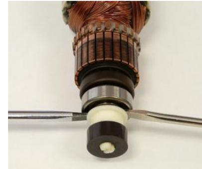
**Anker durch leichte Schläge mit einem Kunststoffhammer aus dem Zwischenlager her austreiben.**
