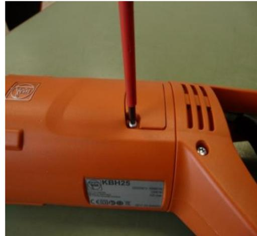
**Feder zurückziehen und Kohlebürste nach unten schieben (auf Kollektor aufsetzen)
