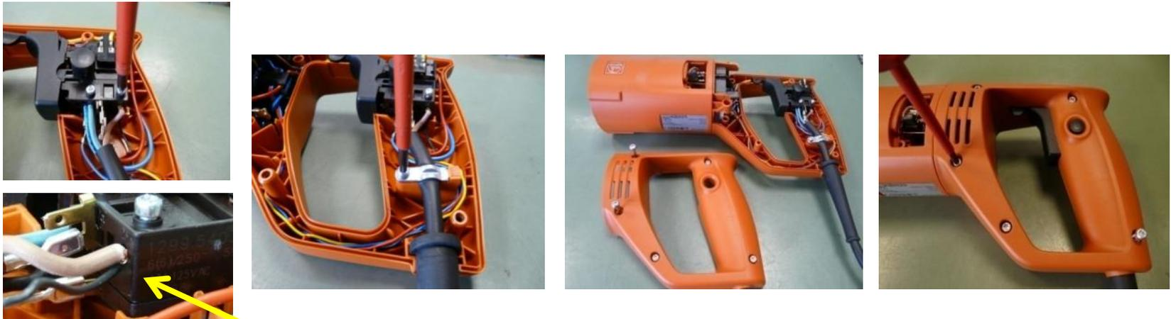
**Netzkabel mit Litze für Wiederanlaufsperr (dünnes schwarzes Kabel) montieren**
