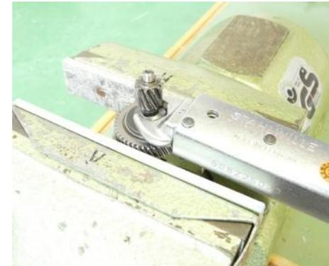
**Rutschkupplung in Schraubstock mit Aluminium-Schutzbacken einspannen.
