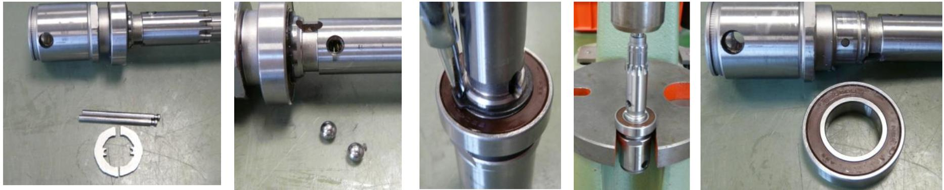
**Beide Bolzen von vorn aus der Bohrwelle herausziehen.
