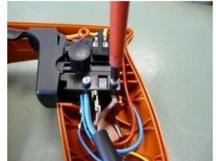
**Schrauben lösen und Handgriffhalbschale abnehmen.
