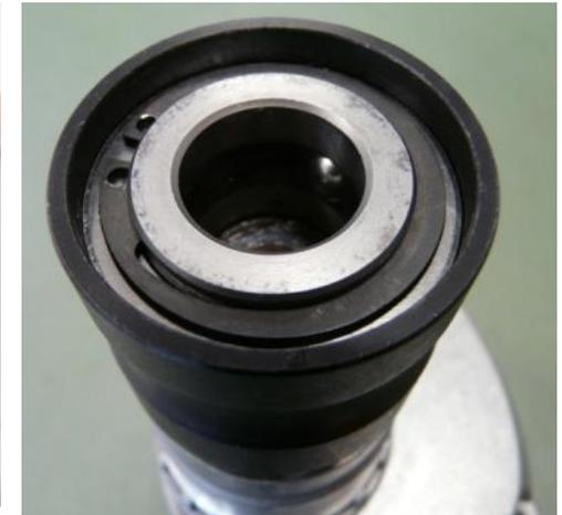
**Bohrwelle mit Sicherungsring im Getriebegehäuse fixieren**
