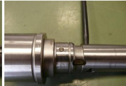
**Feder mit Bolzen einsetzen.**
