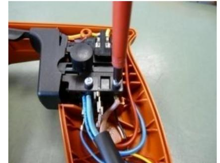
**Soltar los tornillos y extraer el semimonocoque de empuñadura.
