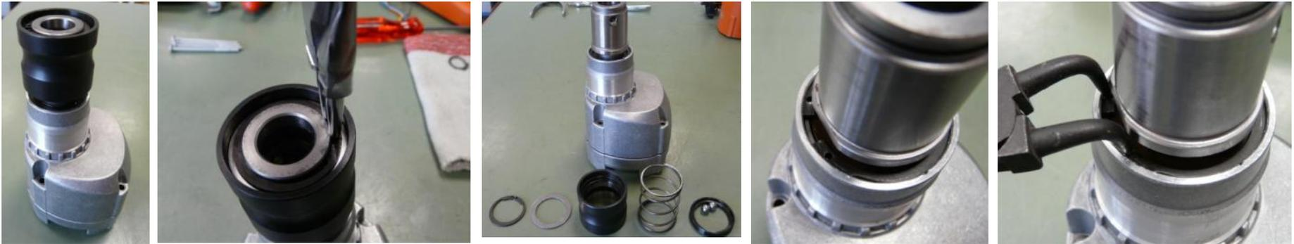
**Colocar la caja de engranajes sobre el cojinete intermedio.**
