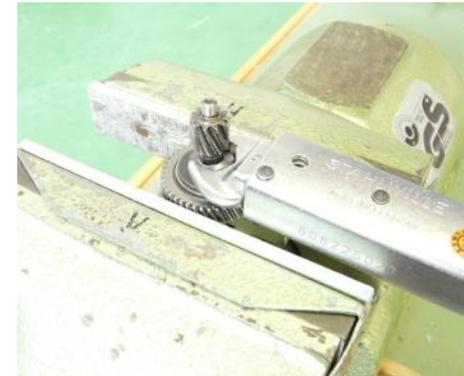
**Sujetar el acoplamiento de fricción en la mordaza con mordazas prensoras de aluminio.**
