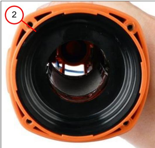
5. Colocar el anillo conductor de aire (2).
