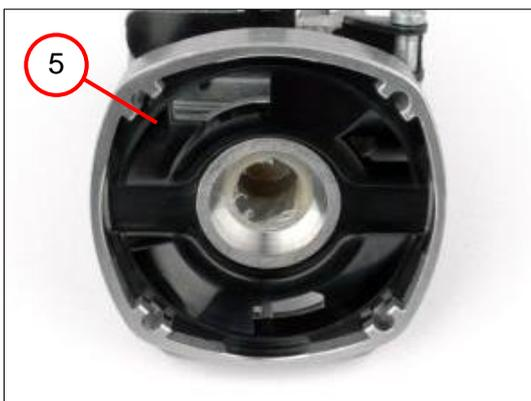
3. Colocar el anillo conductor de aire (5).
