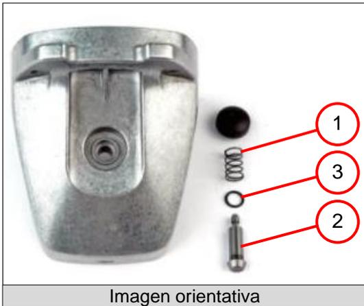
1. Colocar el resorte helicoidal (1) y el perno (2) con junta tórica (3).
