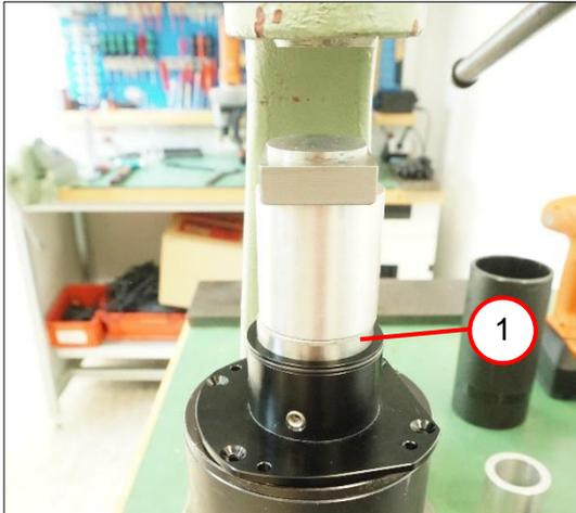
1. Die Rillenkugellager (1) einpressen.
