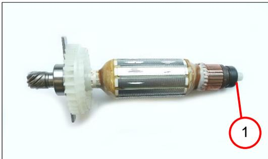
1. Die Lagerbuchse (1) entfernen.
