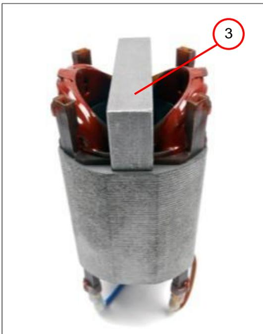
3. Das Druckstück (3) einsetzen.
