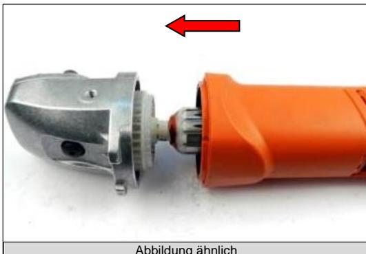
2. Das Getriebegehäuse entfernen.
