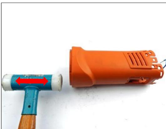
2. Den Stator entfernen.
