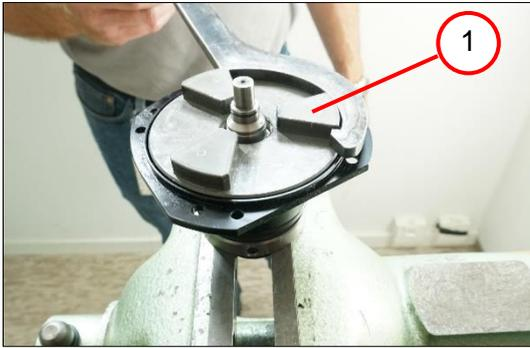
3. Das Lagergehäuse mit der Montagevorrichtung fixieren.
