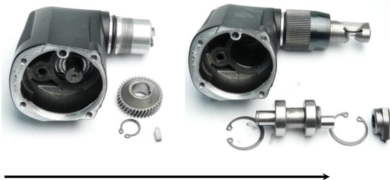
1. Retirer le circlips, la roue dentée et la clavette.
