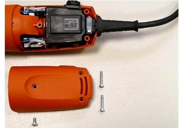
1. Raccorder le câble du moteur au système électronique.
