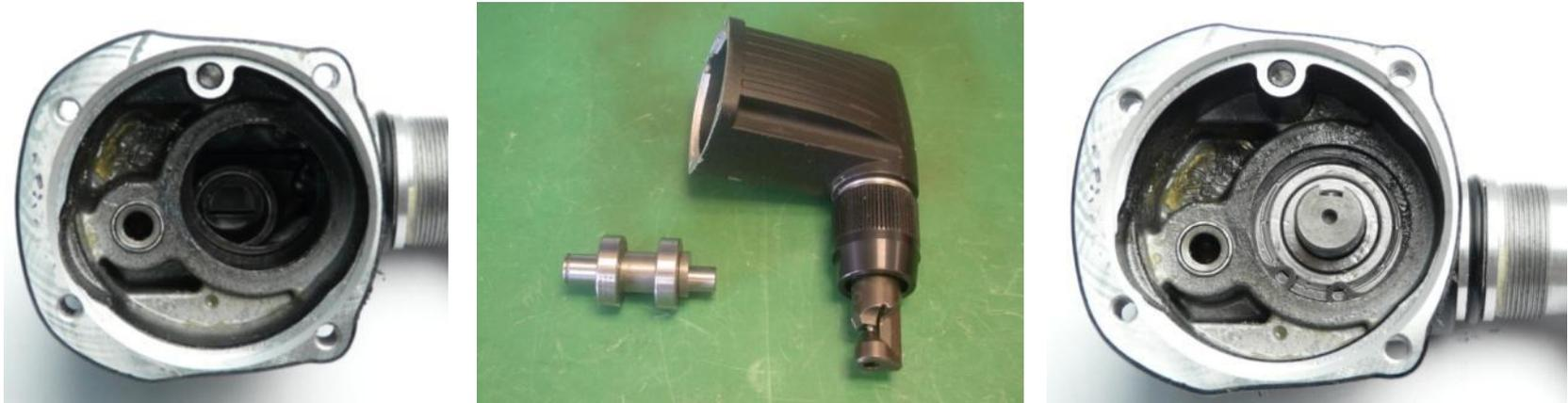
1. Introduire l'entraîneur avec le roulement à aiguilles dans le poussoir.
