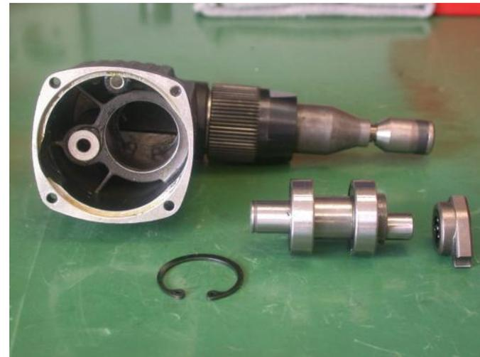
1. Sicherungsring entfernen, Zahnrad und Paßfeder herausnehmen
