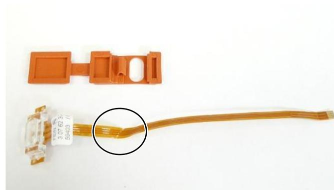
1. Extraer con cuidado del enchufe la electrónica de lámina en el refuerzo.
