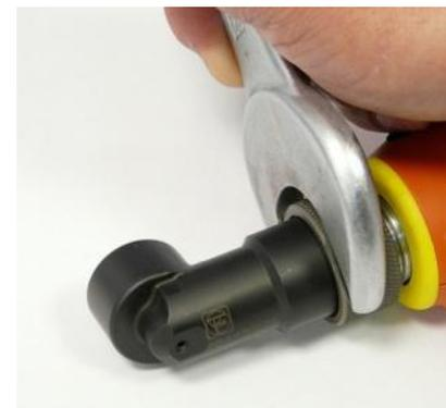
1. Atornillar manualmente la tuerca de rotor hasta el tope.
