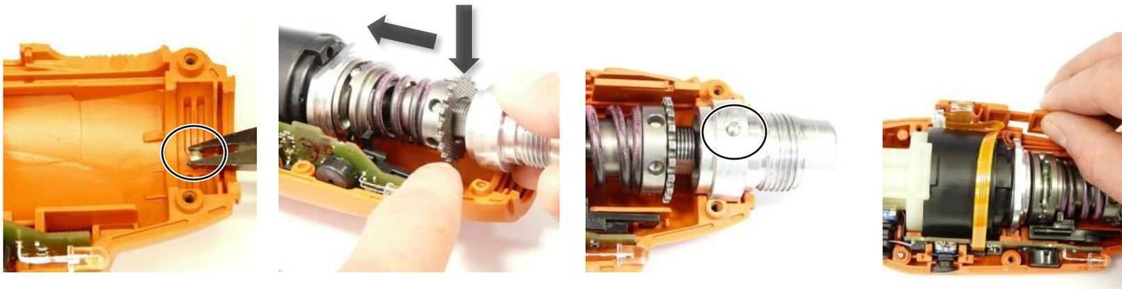
1. Colocar el pasador cilíndrico en la parte inferior de la carcasa.
