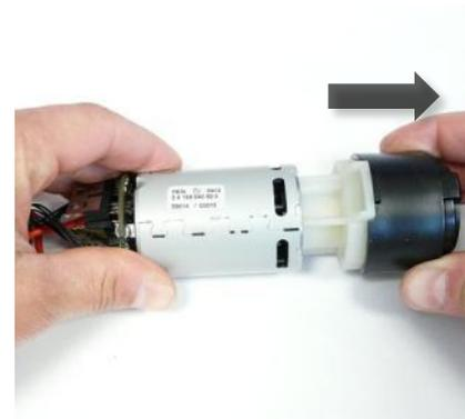
1. Extraer la unidad del motor/engranaje de la mitad inferior de la carcasa.
