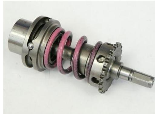
1. Insertar el resorte helicoidal y el anillo en el portaherramientas.
