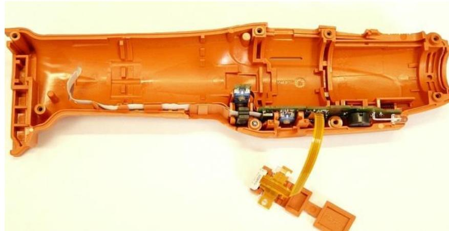
1. Colocar el cable plano en las guías y el circuito electrónico en la parte inferior de la carcasa.
