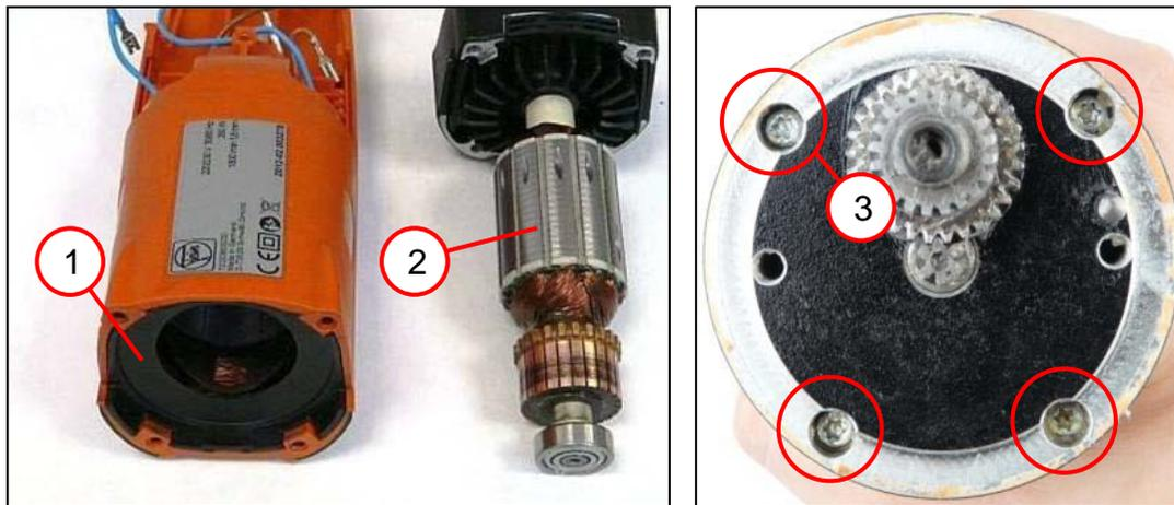
1. Den Luftleitring (1) in Gehäuse einsetzen.
