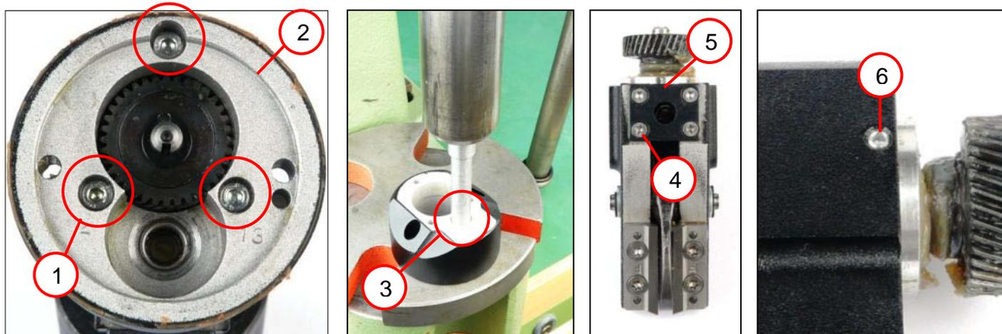
1. Die drei Schrauben (1) herausdrehen und den Adapter (2) entfernen.
