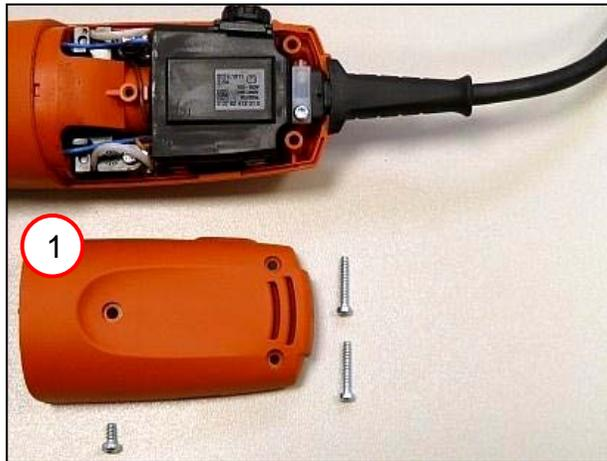
1. Den Deckel (1) aufsetzen und festschrauben [1,5 +0,1Nm].
