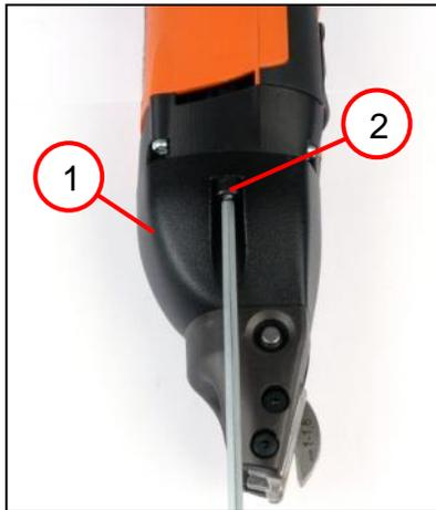
1. Das Gehäuse mit Maschinenkopf (1) auf das Zwischenlager aufsetzen.
