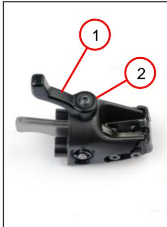
1. Den Griff (1), wie im Bild, auf die Rändelschraube setzen und mit der Linsenschraube (2) befestigen [2 Nm].
