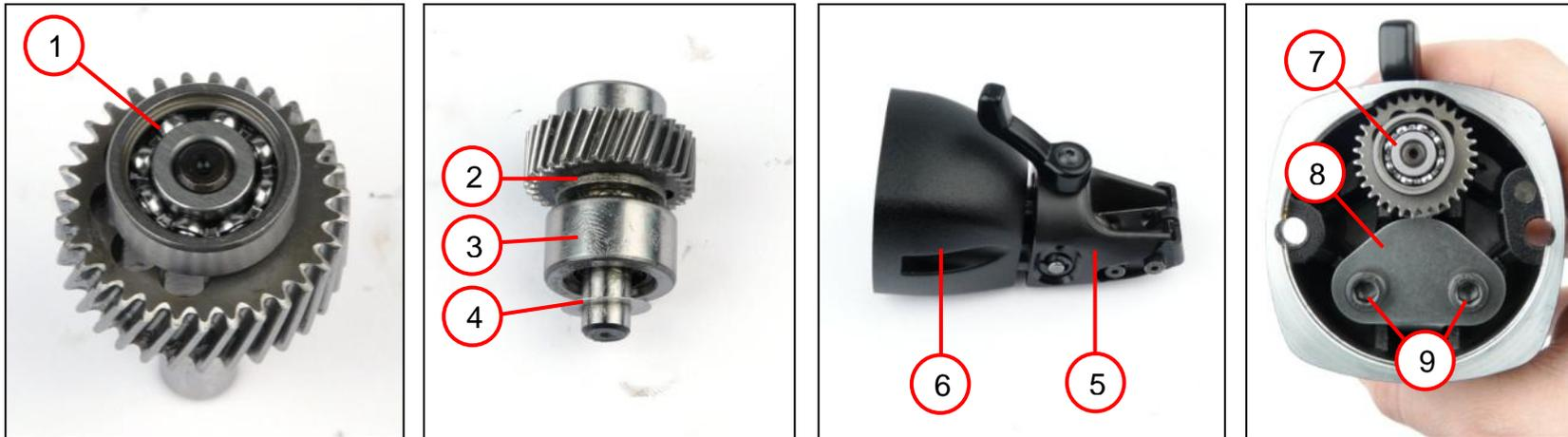
1. Das Rillenkugellager (1) auf die Exzenterwelle aufpressen.
