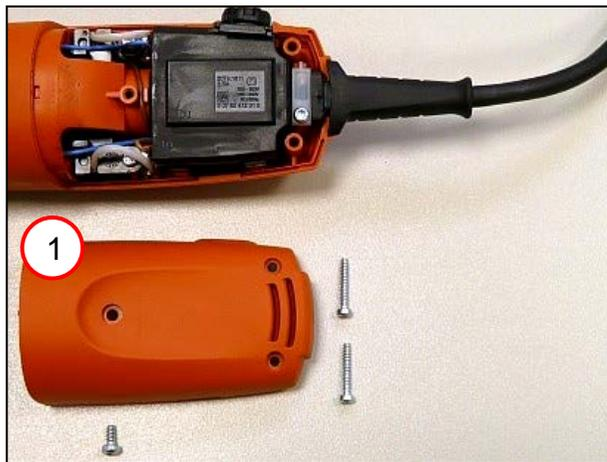
1. Den Deckel (1) aufsetzen und festschrauben [1,5 +0,1Nm].
