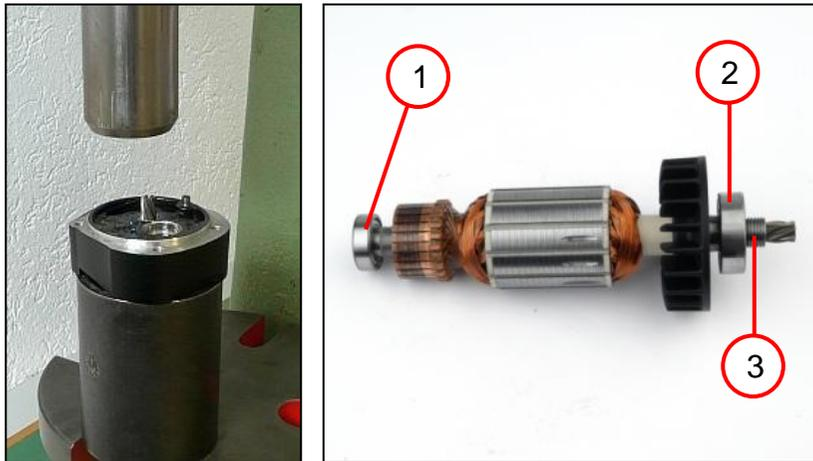
1. Den Anker aus dem Zwischenlager auspressen.
