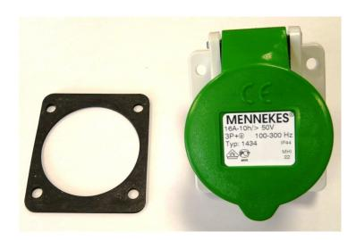
Ne pas oublier le joint en caoutchouc lors du remplacement de la prise de courant et veiller à un raccordement adéquat. L1 = noir, L2 = gris, L3 = blanc, SL = jaune/vert Vérifier <u>impérativement</u> le sens de rotation après le raccordement des câbles.
