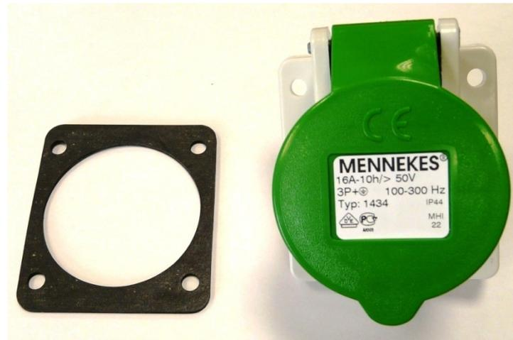
更换插座时不要忘记安装橡胶密封件并注意应正确连接。L1 = 黑色，L2 = 灰色，L3 = 白色，SL = 黄色/绿色
