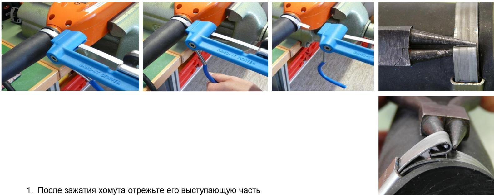
1. После зажатия хомута отрежьте его выступающую часть встроенным режущим инструментом.
