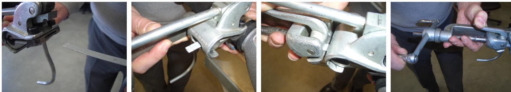
1. Вставьте металлическую планку хомута в специальный инструмент.
