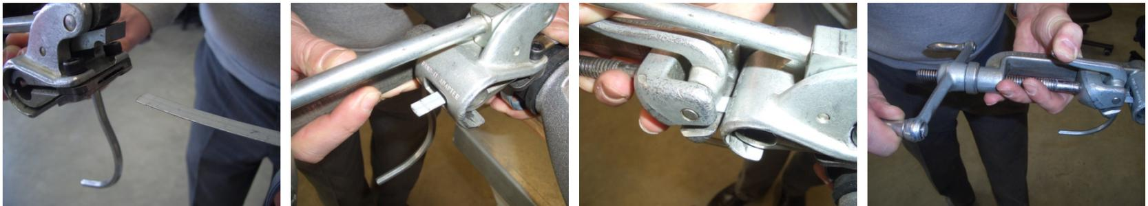
1. Introducir la brida metálica de la abrazadera de manguito en la herramienta especial
