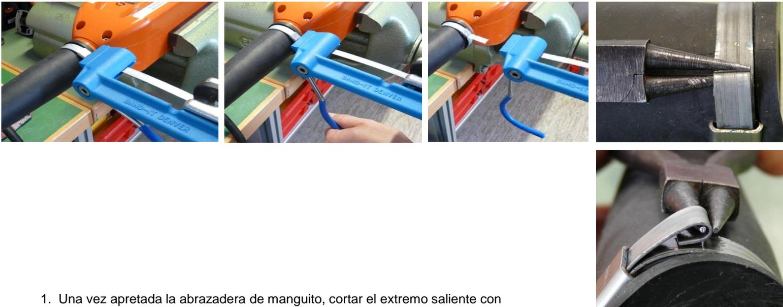
1. Una vez apretada la abrazadera de manguito, cortar el extremo saliente con la herramienta de corte integrada.
