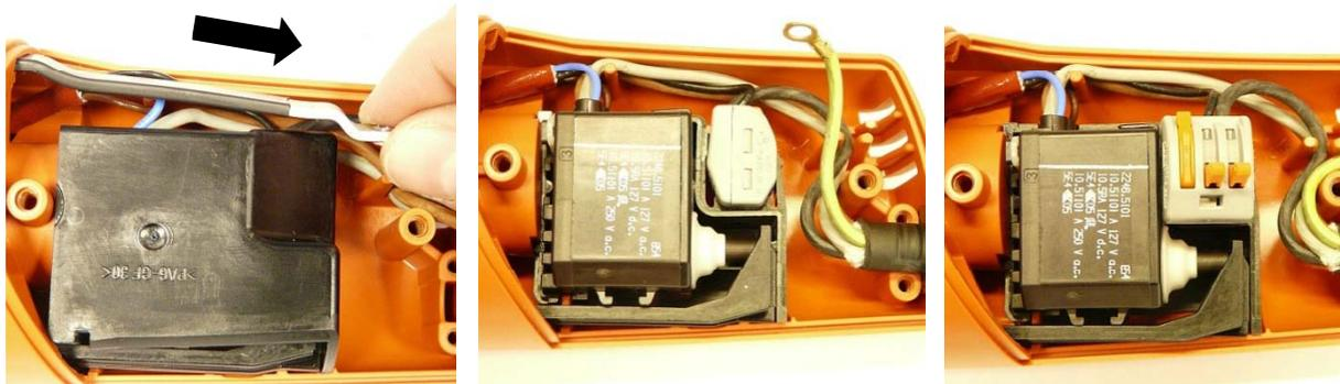
1. 拔出接地母线。
