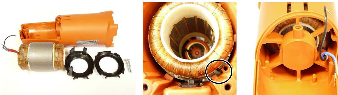
1. 将定子装入外壳中，使定子上的凹槽与外壳上的凹槽对齐。
