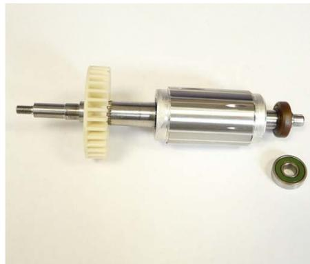
1. 使用拆卸装置拔出轴承。
