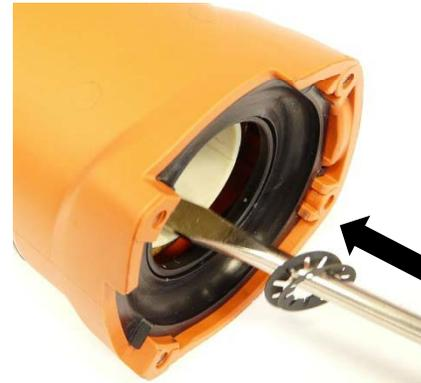
1. 将盘形弹簧正确地插入外壳的轴颈中。
