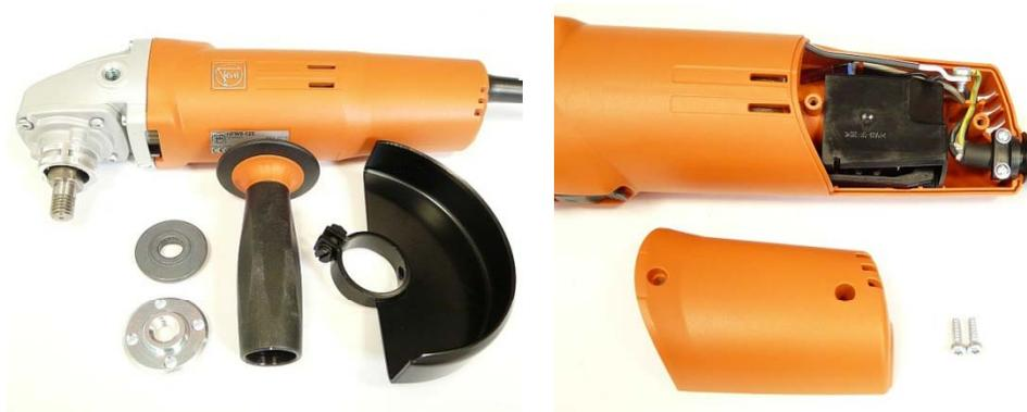
1. 旋下螺纹法兰、内置法兰、护罩和手柄。
