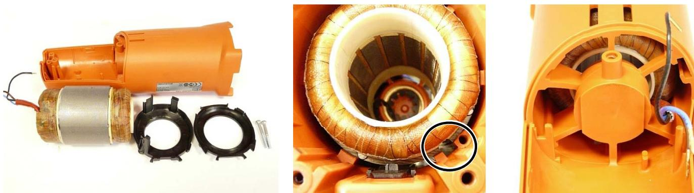
1. Insérer le support dans le carter de sorte que les rainures sur le support et dans le carter soient alignées.
