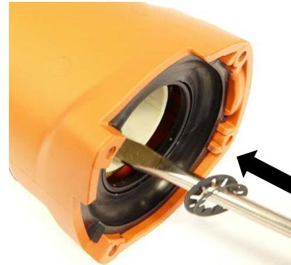
1. Insérer les ressorts correctement dans le logement du palier dans le carter.
