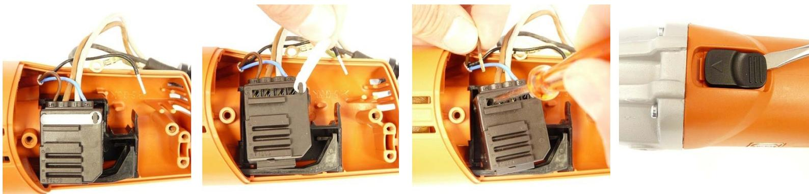
1. Retirer l'interrupteur et tourner vers la droite.
