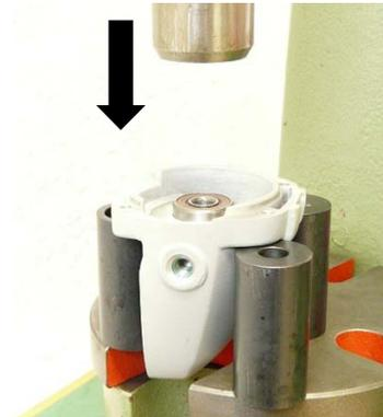
1. Insérer le palier au centre du logement du palier.
