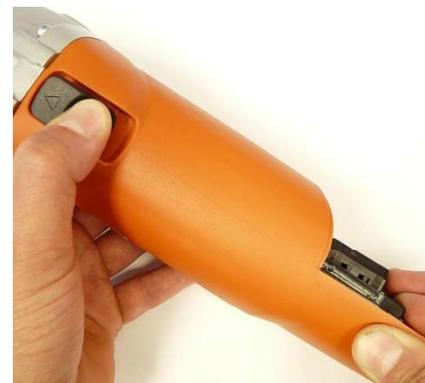
1. Appuyer sur le bouton de commande situé sur l'interrupteur à l'aide de la tringle de commande et maintenir enfoncé.
