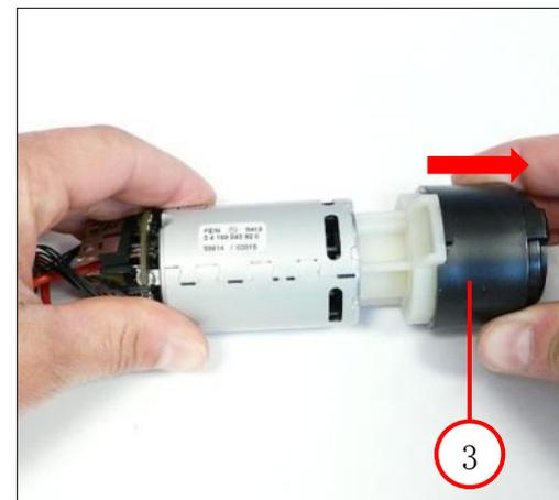
1. 从下半部分机壳中取出电机/齿轮传动装置 (1)。
