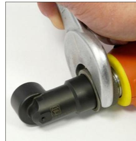
1. 手动将螺纹环 (1) 拧紧至止挡处。
