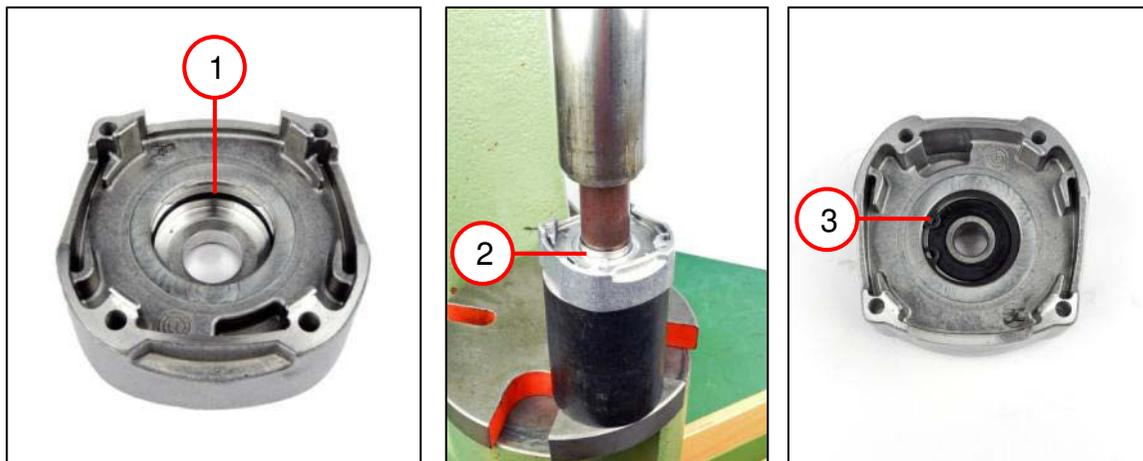
1. Enduire d'huile la bague d'étanchéité (1).
