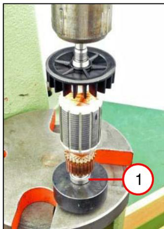
1. Emmancher le roulement à billes (1) sur le rotor.
