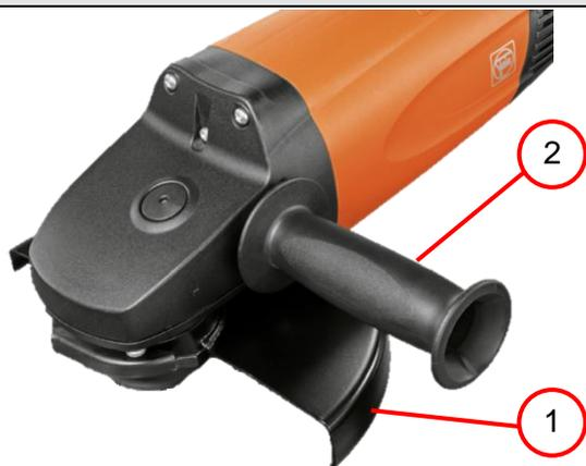
1. Montar la cubierta de protección (1).
