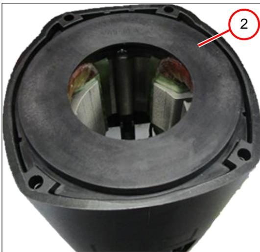
6. Colocar el anillo conductor de aire (2).
