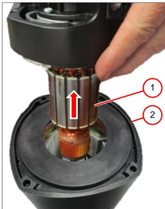
3. Extraer el inducido (1) de la carcasa del motor (2).
