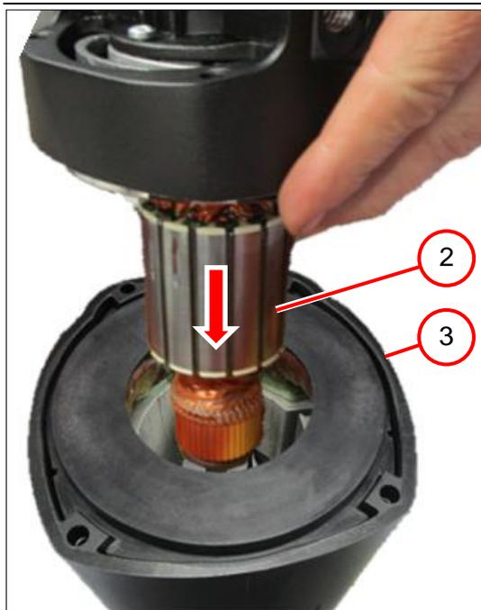
2. Colocar el inducido (2) en la carcasa del motor (3).
