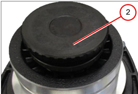
2. Die Spanneinheit (2) entfernen.
