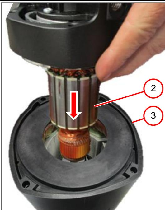
2. Den Anker (2) im Motorgehäuse (3) platzieren.
