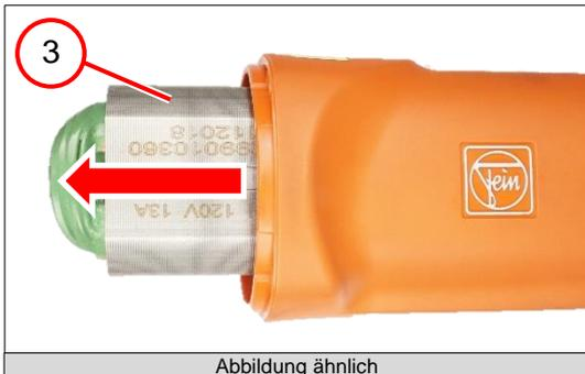
6. Den Stator (3) entfernen.
