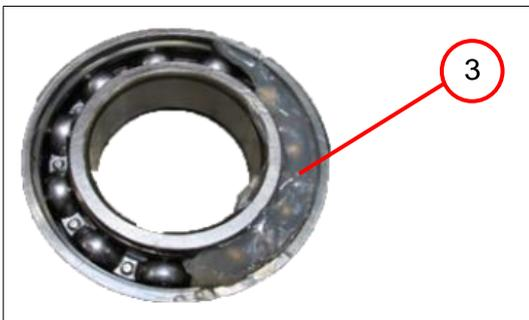
4. Das Rillenkugellager (3) einfetten.
