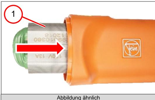
1. Den Stator (1) ausrichten.
