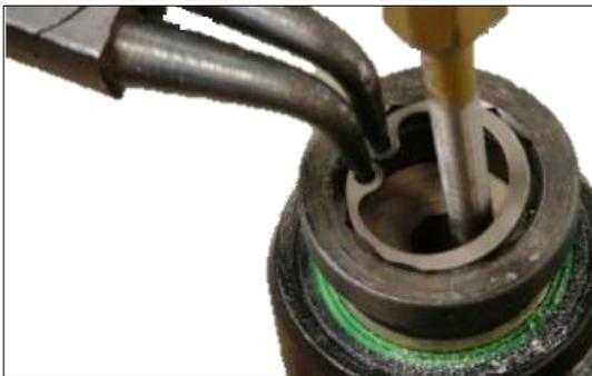
1. Den Sicherungsring (1) entfernen.
