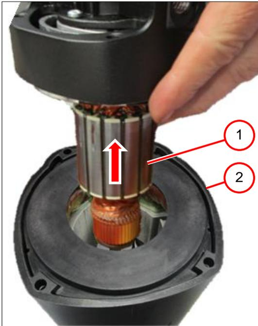
3. Den Anker (1) aus dem Motorgehäuse (2) entfernen.
