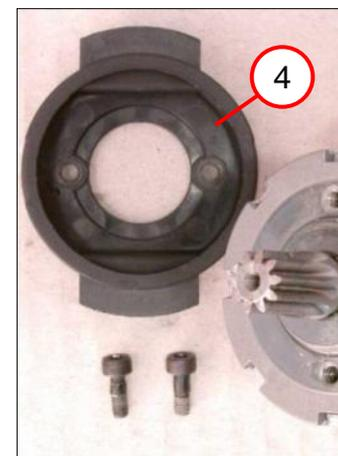
1. Retirer l'engrenage (1) du moteur EC (2).
