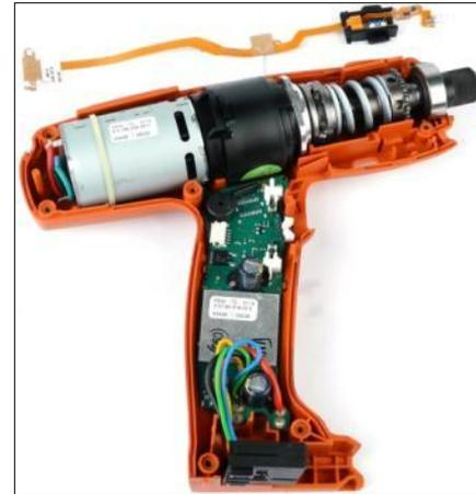
1. Retirer le curseur de commande à ressort de pression (1) et le bouton-poussoir à ressort de pression (2).
