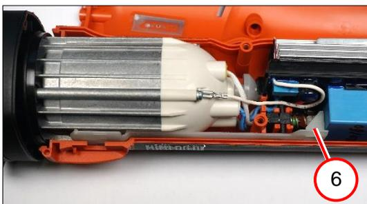
8. Die Schaltstange (6) entfernen.
