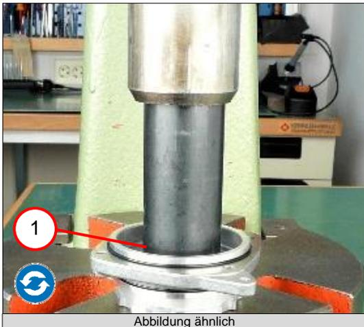
1. Das Rillenkugellager (1) einpressen.
