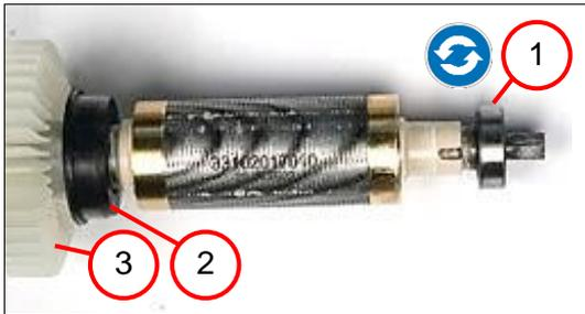
1. Das Rillenkugellager (1) abziehen.
