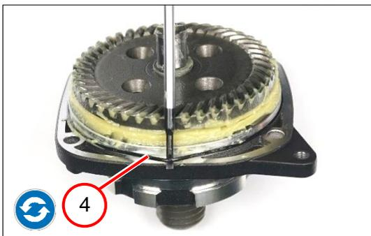
4. Den Dichtring (4) entfernen.
