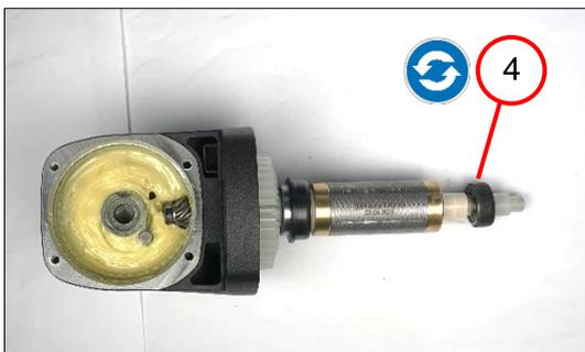
3. Die Gummibuchse (4) entfernen.
