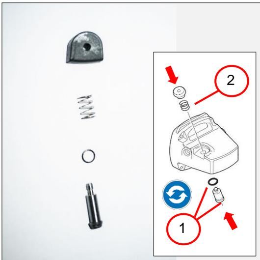
1. Den Bolzen mit Dichtring (1) platzieren.
