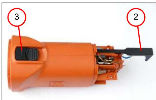
3. Mettre en place la tringle de commande (2).
