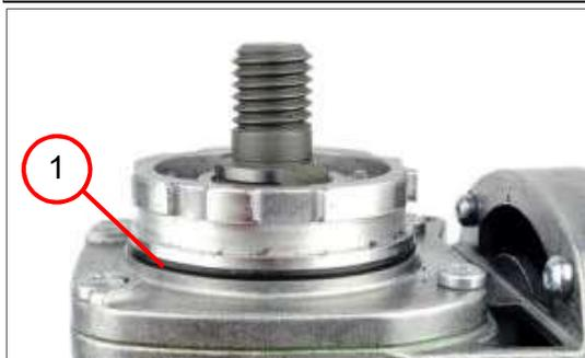
1. Retirez la bague d'étanchéité (1).
