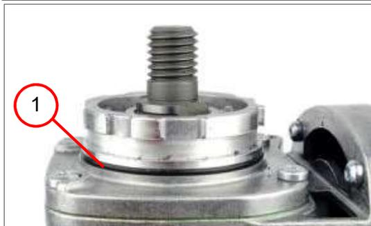
1. Retirez la bague d'étanchéité (1).
