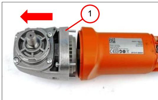
6. Снимите корпус редуктора (1).
