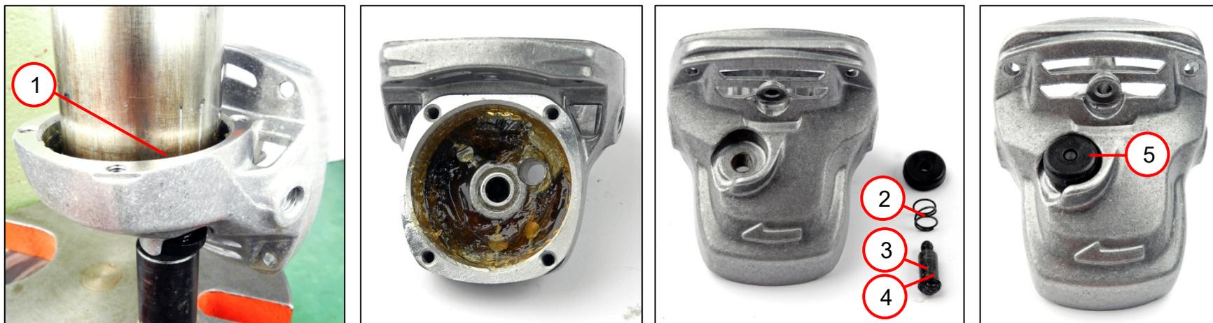
1. Presionar el rodamiento de agujas (1) en la caja de engranajes.
