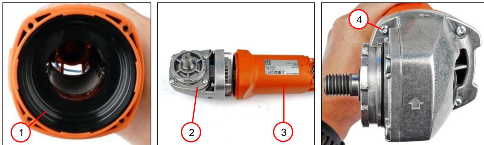
1. Instalar el anillo conductor de aire (1) en la carcasa de motor.
