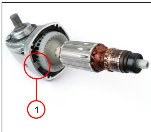
1. Insertar por presión el inducido en la caja de engranajes.
