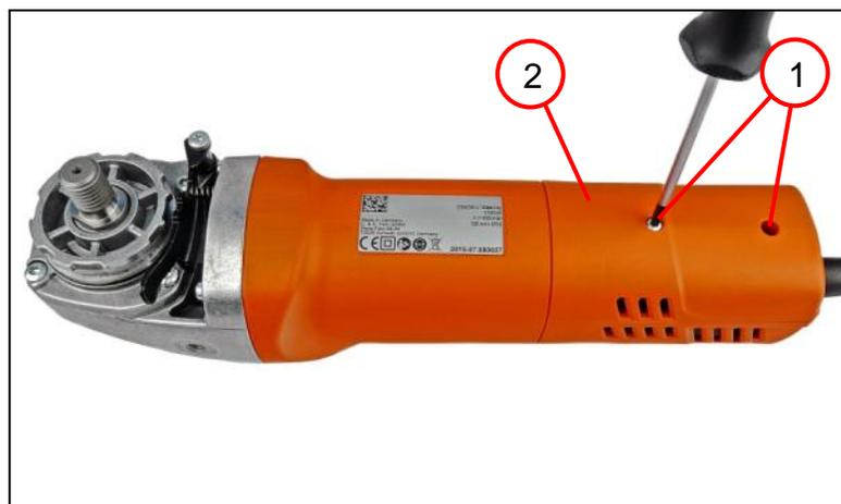
1. Desenroscar los dos tornillos (1) y desmontar la parte inferior de la tapa (2).
