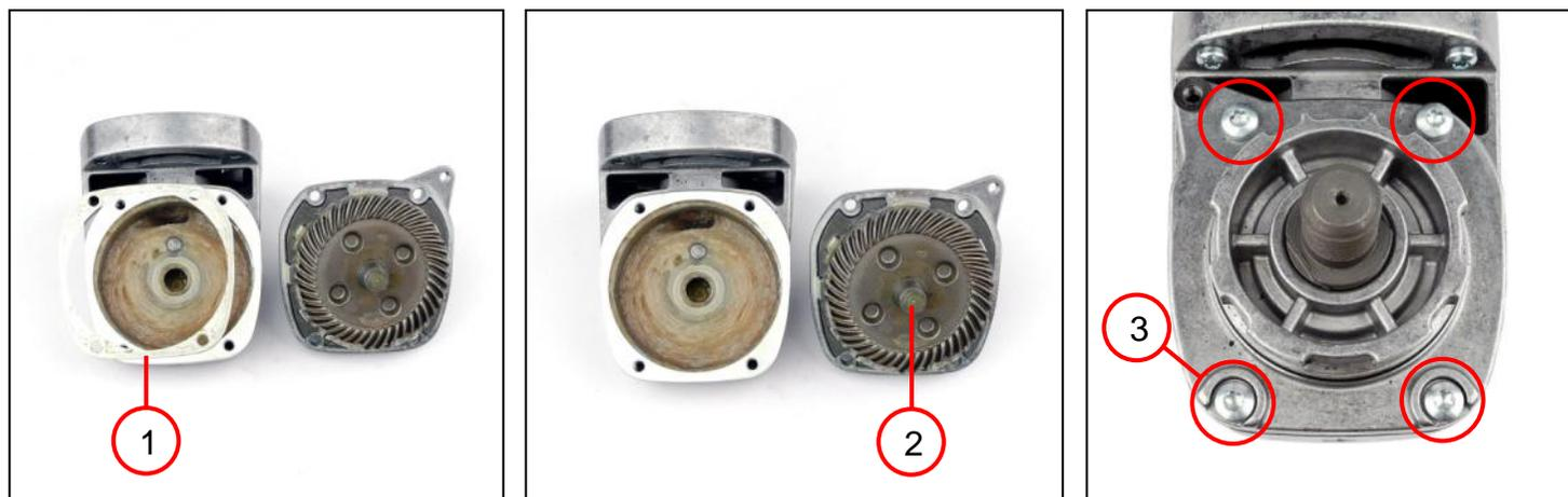
1. Untar con Loctite 573 la/s arandela espaciadora/s (1) por ambos lados y posicionarla/s sobre la caja de engranajes.
