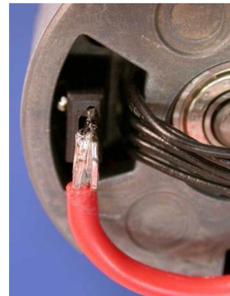
**！按照接线图和图示钎接绞合线，否则将无法启用功能，并且无法进行稍后的安装！**
