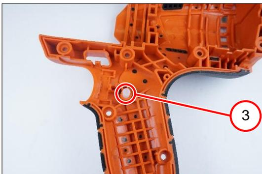
7. Das Druckstück (3) entfernen.
