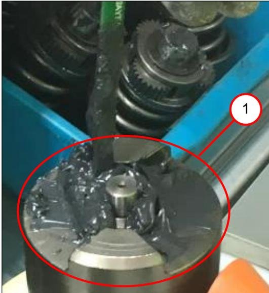
1. Die Aussparung, den Spalt und die Backen (1) mit 6 g Fett befüllen.
