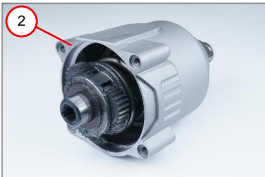
2. Das Getriebegehäuse (2) entfernen.
