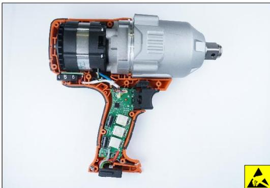
8. Alle Bauteile aus dem Motorgehäuse entfernen.
