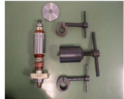
1. Ankerritzel in Abziehplatte einlegen und mittels Durchschlag und einer Dornpresse abdrücken.
