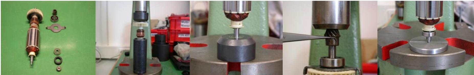
1. Anker in Aufpressvorrichtung einsetzen.
