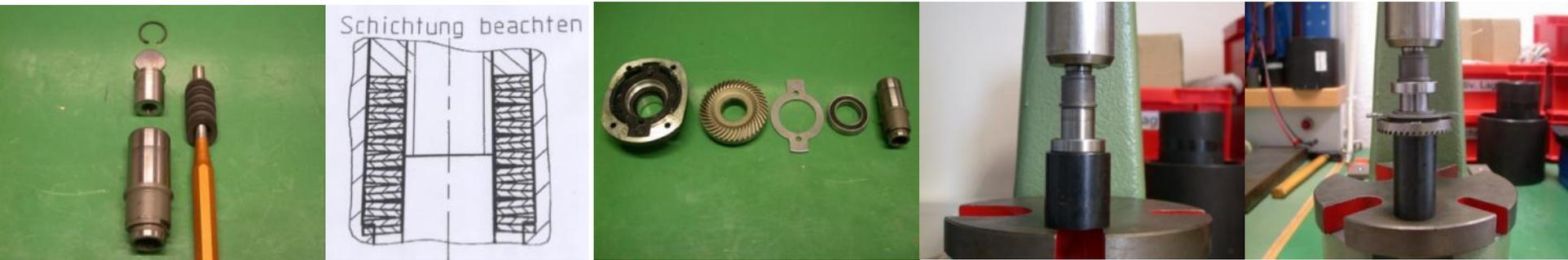
1. Federpaket, Druckstück und Druckplatte in Antriebswelle einsetzen
