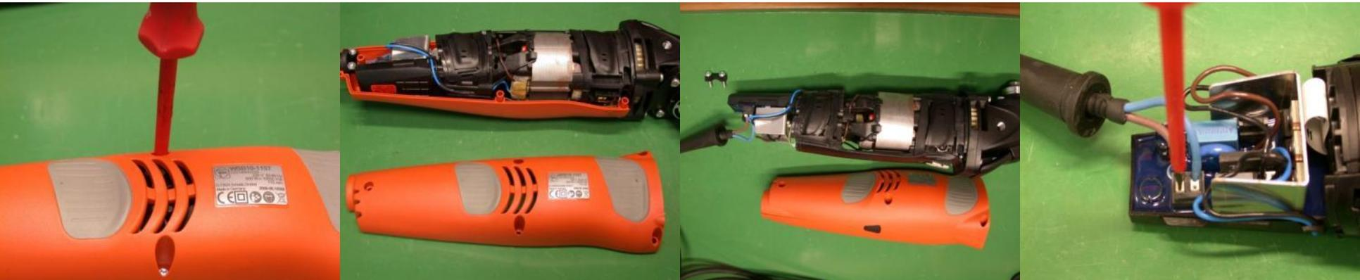
1. Gehäuseschrauben ( 5x ) lösen
