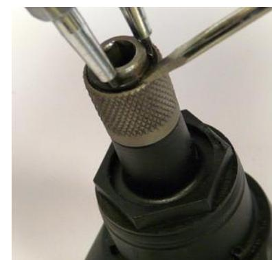
1. Colocar la bola (para la fijación de la broca de la atornilladora) con un poco de grasa en el agujero del portaherramientas.
