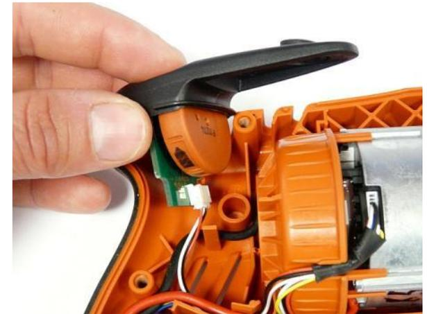
1. Colocar los cables delgados del motor debajo del cable rojo.
