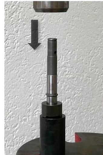
1. Montar a presión el anillo de levas sobre el portaherramientas.
