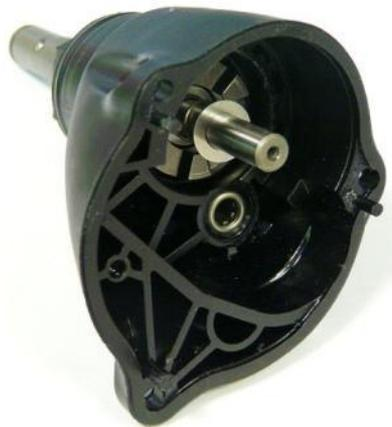
1. Insertar el disco, el resorte y el segundo disco en el portaherramientas.
