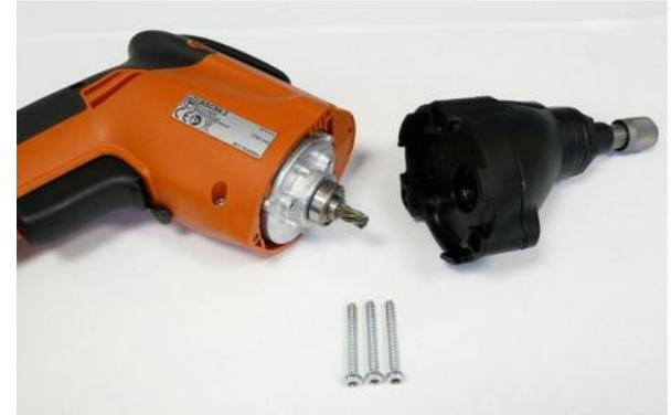
1. Akku, Tiefenanschlaghülse, Überwurfhülse und Schrauberbit demontieren.
