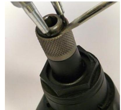
1. Kugel (für die Fixierung des Schrauberbits) mit etwas Fett in die Bohrung des Werkzeugträgers legen.
