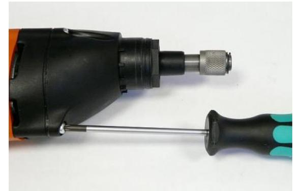
1. Gehäuseoberteil aufsetzen und festschrauben.
