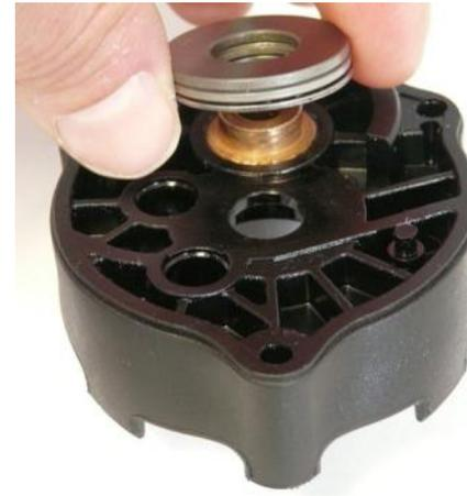
1. Gleitlagerbuchse im Zwischenlager mit Fett befüllen.
