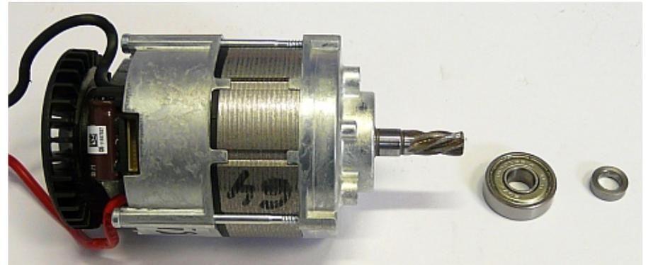
1. Kugellager und Dichtring vom Motor abziehen.
