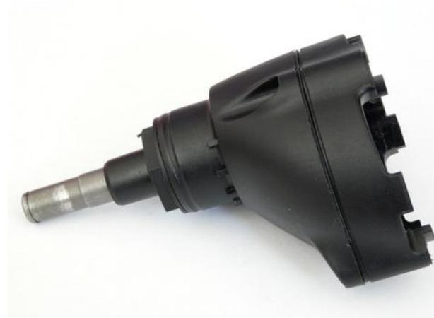
1. Getriebe mit Fett befüllen (10 g).
