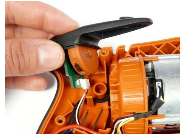
1. Die dünnen Kabel vom Motor unter das rote Kabel legen.
