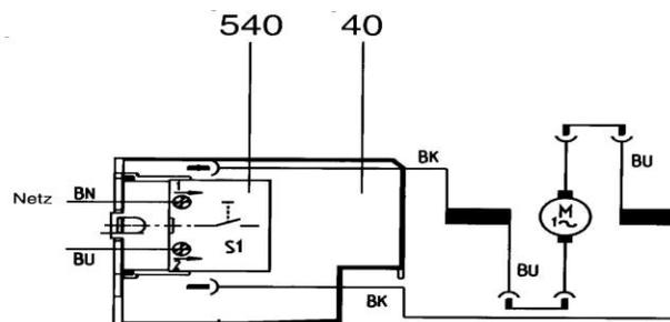
Prüfschaltung für ausgebaute Elektronik
