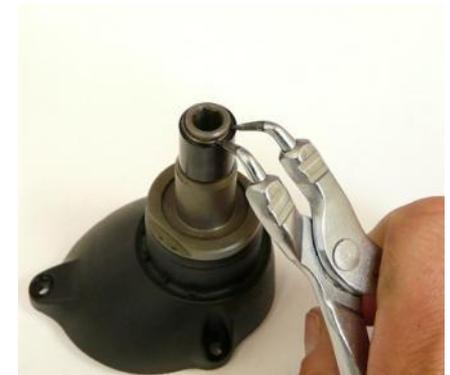
1. Kugel (für die Fixierung des Schrauberbits) mit etwas Fett in die Bohrung des Werkzeugträgers legen.
