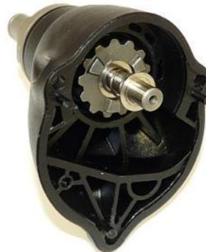
1. Nockenring, Scheibe, Feder und zweite Scheibe auf den Werkzeugträger schieben.
