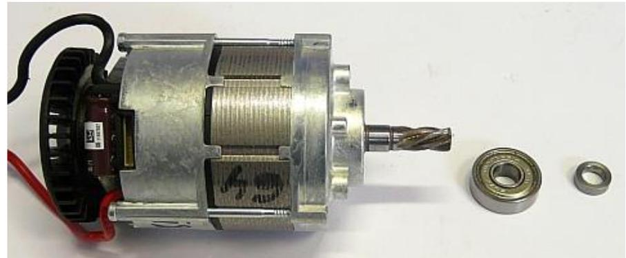
1. Kugellager und Dichtring vom Motor abziehen.
