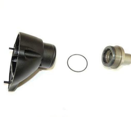
1. Lagerbuchse vom Getriebekopf abschrauben.
