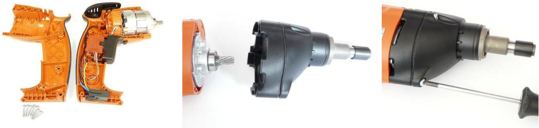
1. Gehäuseoberteil aufsetzen und festschrauben.
