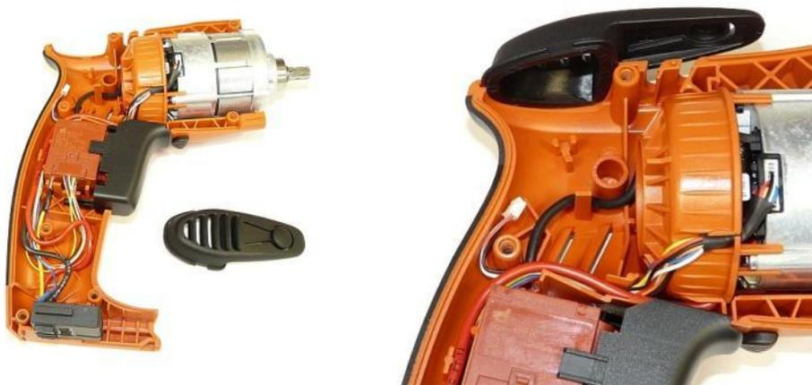
1. Gürtelhaken in das Gehäuseunterteil einsetzen.
