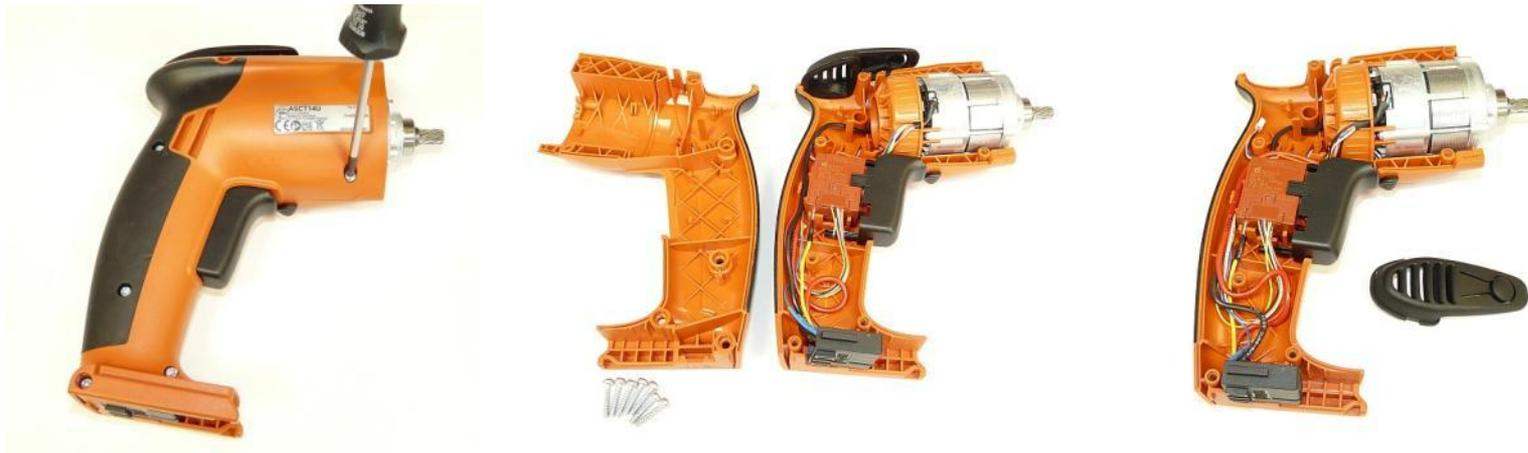
1. Schrauben am Gehäuseoberteil lösen und Gehäuseoberteil abnehmen.
