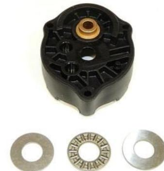
1. Axialscheibe und die beiden Scheiben vom Zwischenlager abnehmen.
