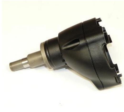
1. Getriebe mit Fett befüllen (10 g).
